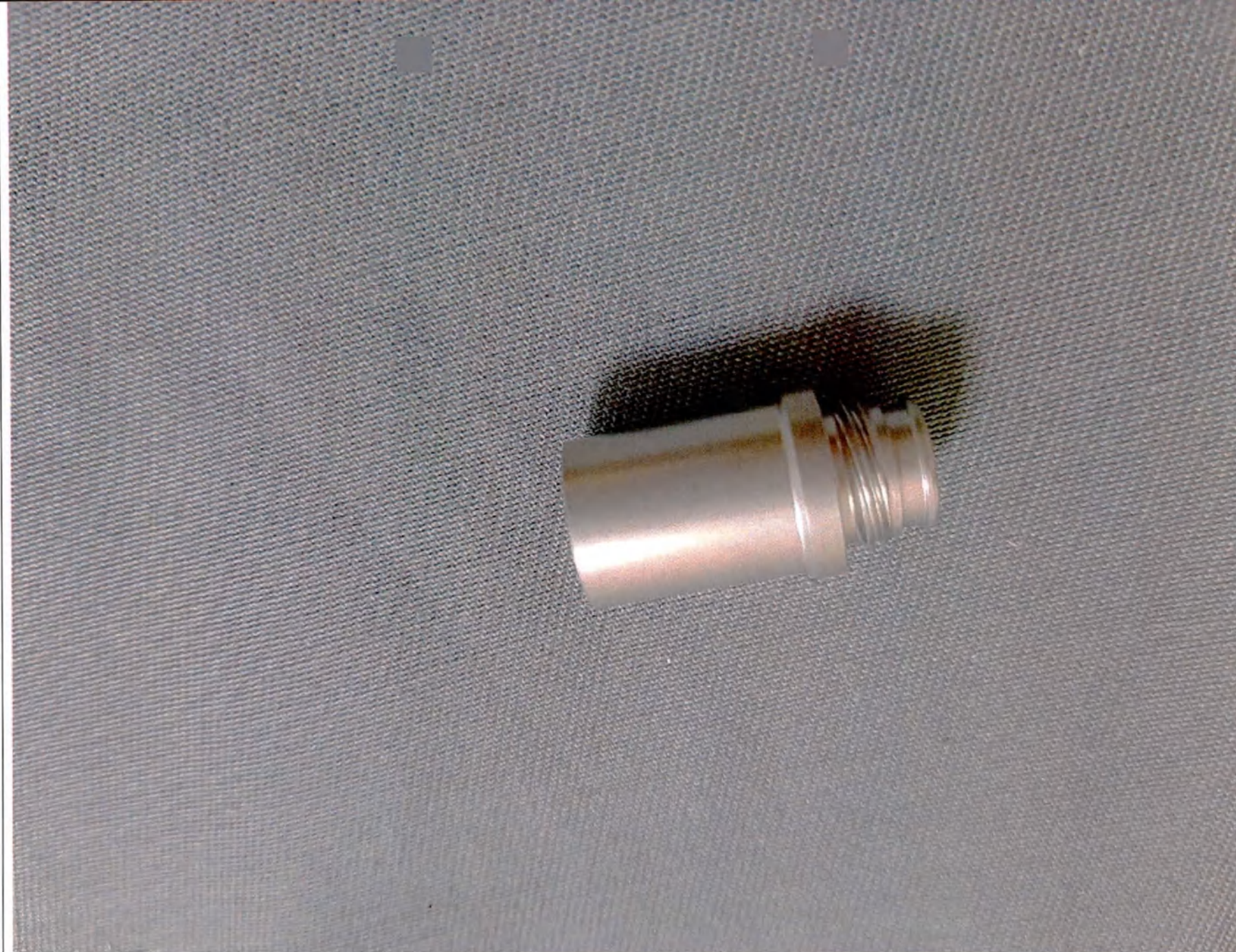
Рис. 32. Адаптер световодов KARL STORZ и Olympus.
