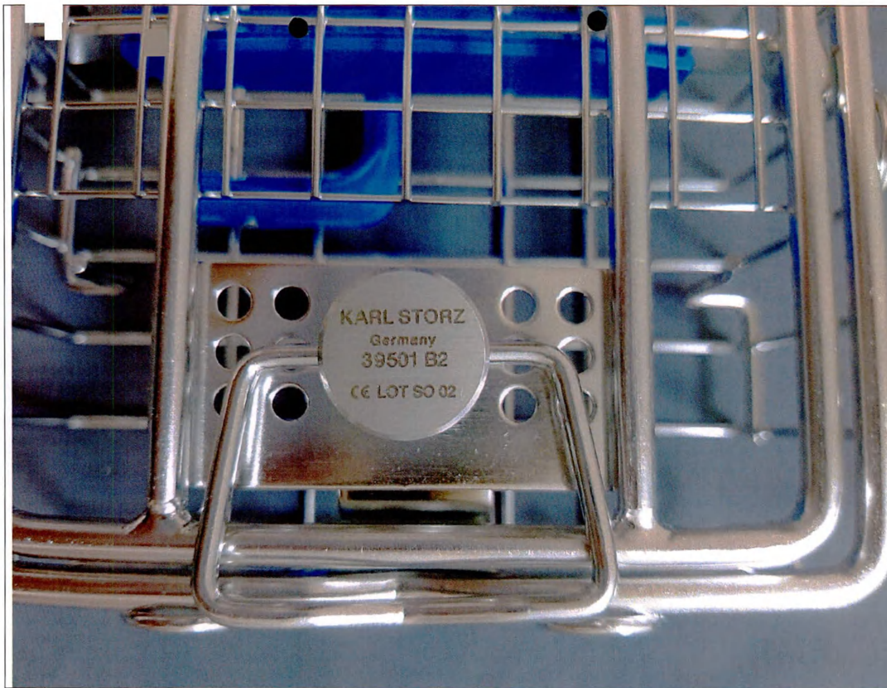
Рис. 52. Контейнер проволочный для дезинфекции/стерилизации/хранения, размеры: 352 x 125 x 54 мм.
