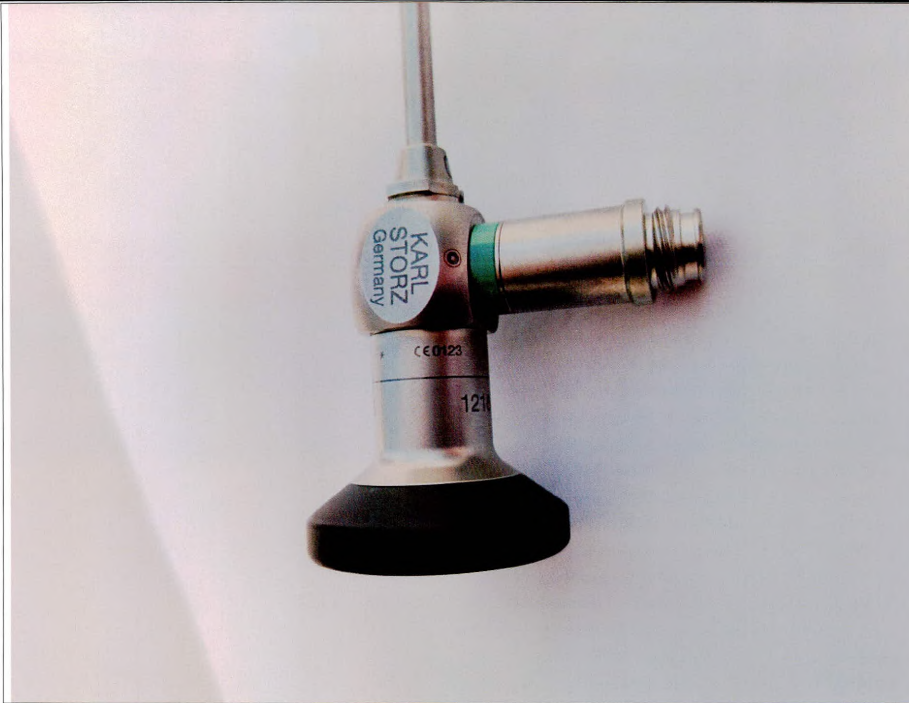
Рис. 10. Отоскоп жесткий HOPKINS, типоразмер: направление наблюдения 0°, диаметр 4 мм, длина 11 см.
