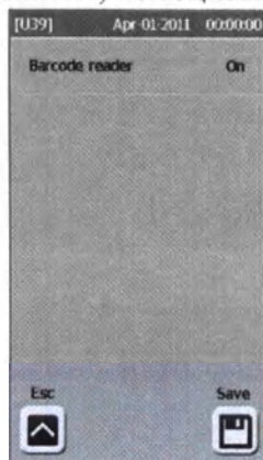
Рисунок 19 – Настройка сканера штрих-кодов
