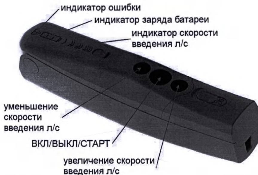
Рисунок 2 – Изделие, расположение внешних конструктивных элементов
