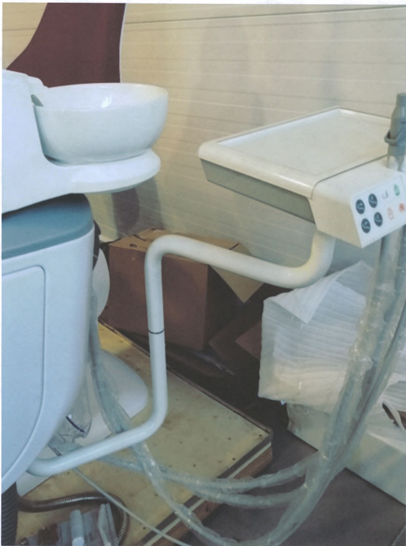
Столик ассистента для серии X5: плечо пантографическое для столика ассистента для серии X5
