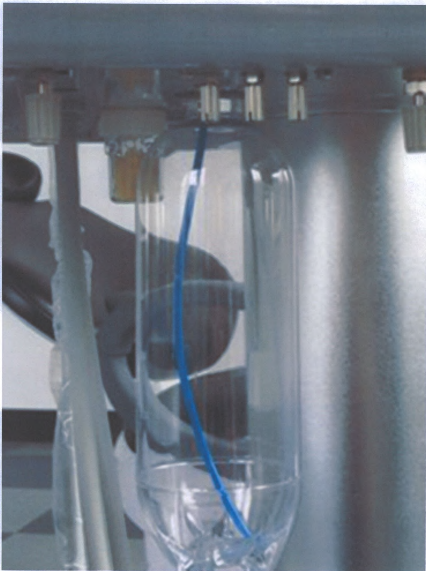
Гидроблок X5 + Implant: бутылка для воды и дезинфицирующей жидкости для установки под столиком врача
