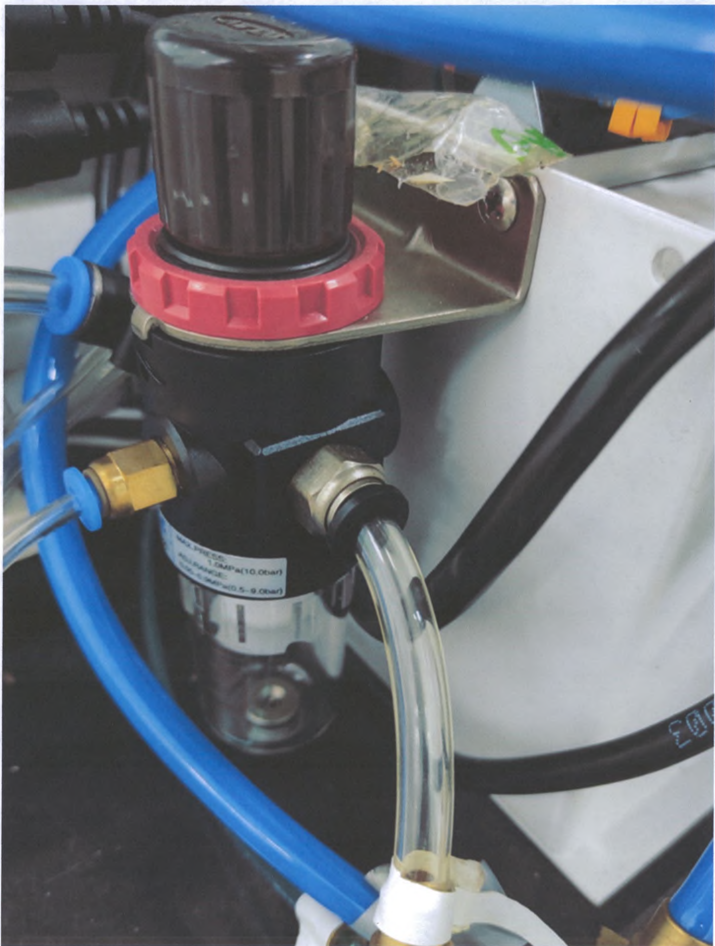
51 Фильтр воздушный 5 мкм
