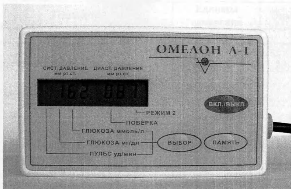
Рисунок 2. Измерительный блок с панелью управления
