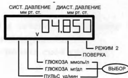
Рисунок 15. Отображение концентрации глюкозы в крови - 4,85 ммоль/л
