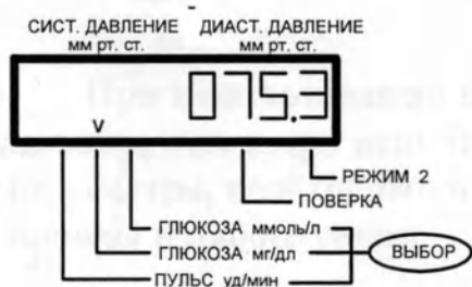
Рисунок 14. Отображение концентрации глюкозы в крови - 75,3 мг/дл
