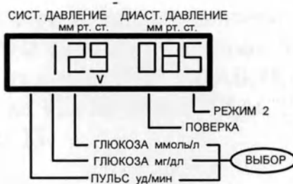
Рисунок 11. Отображение величины систолического и диастолического давлений - 129 на 85 мм рт. ст.
