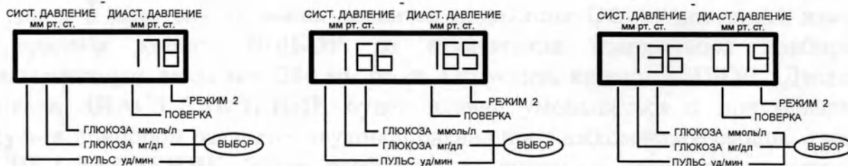
Рисунок 10. Отображение величин давлений в манжете в процессе и в конце измерения
