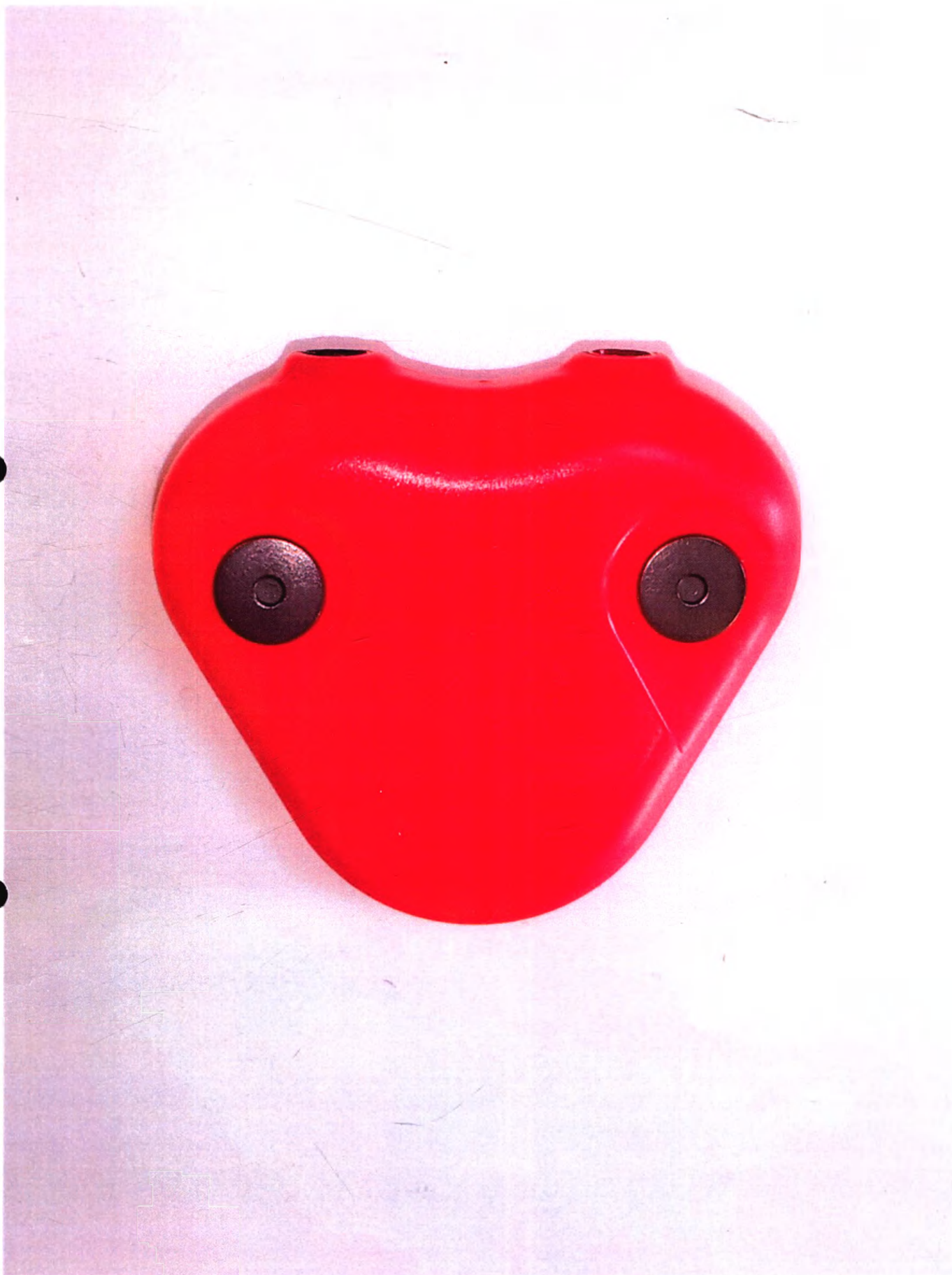
Вид верхней панели индикатора кардиоритма «ИКР» (исполнение ИКР-1)
