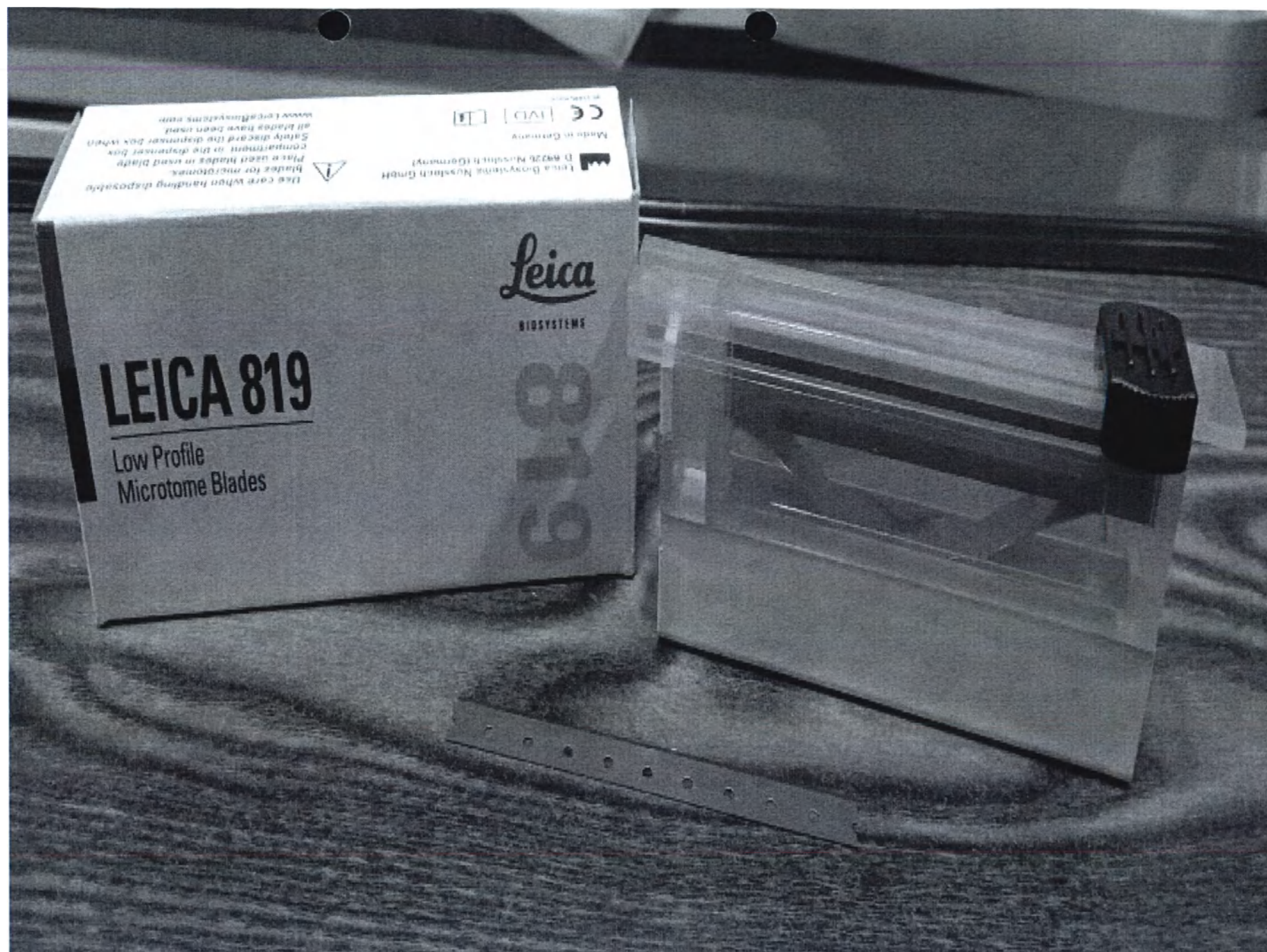
24. Лезвия одноразовые — низкого профиля (80 × 8 × 0,25 мм) (Disposable blades – low-profile)
