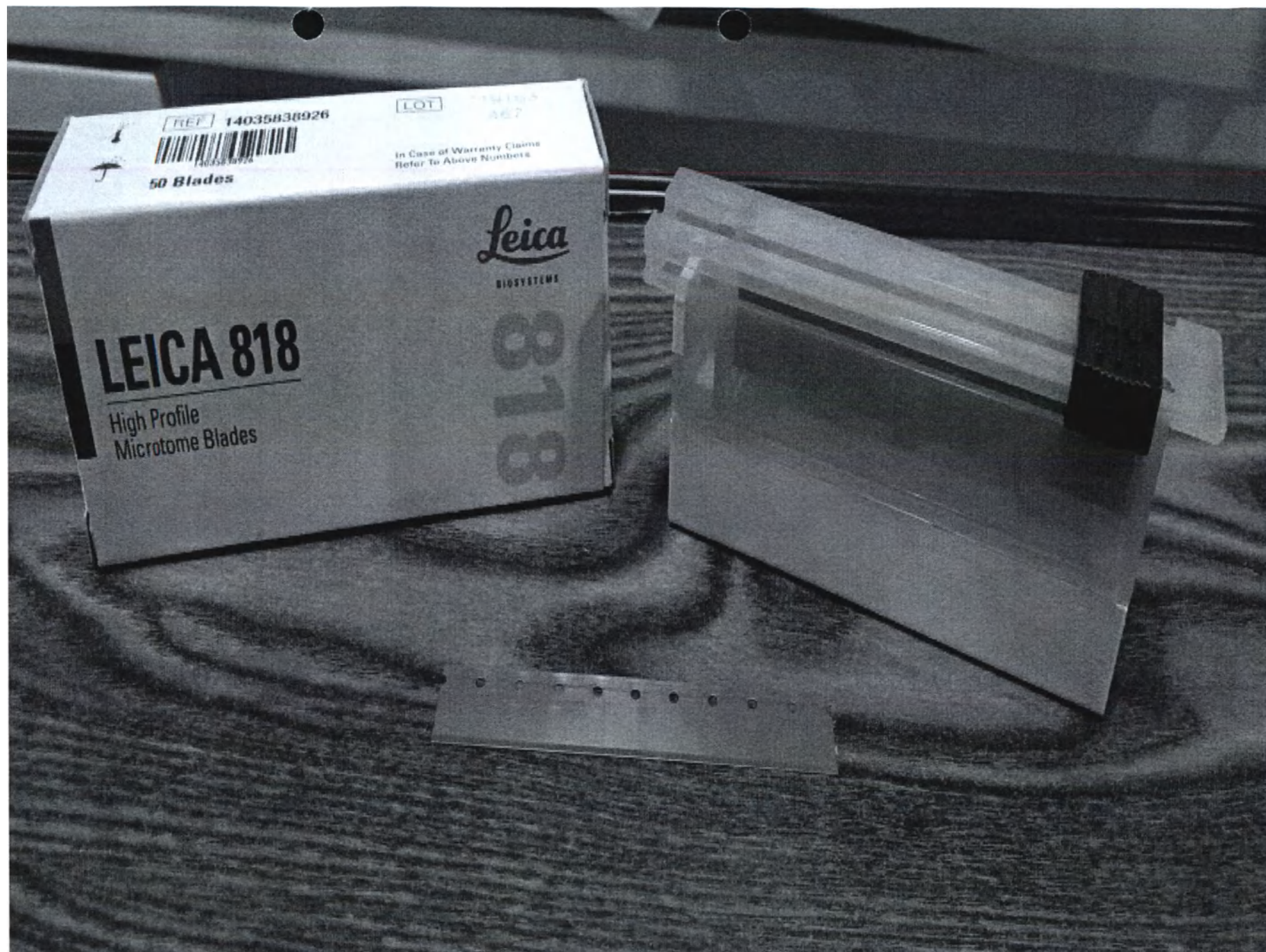
25. Лезвия одноразовые — высокого профиля (80 × 14 × 0,35 мм) (Disposable blades – high-profile)
