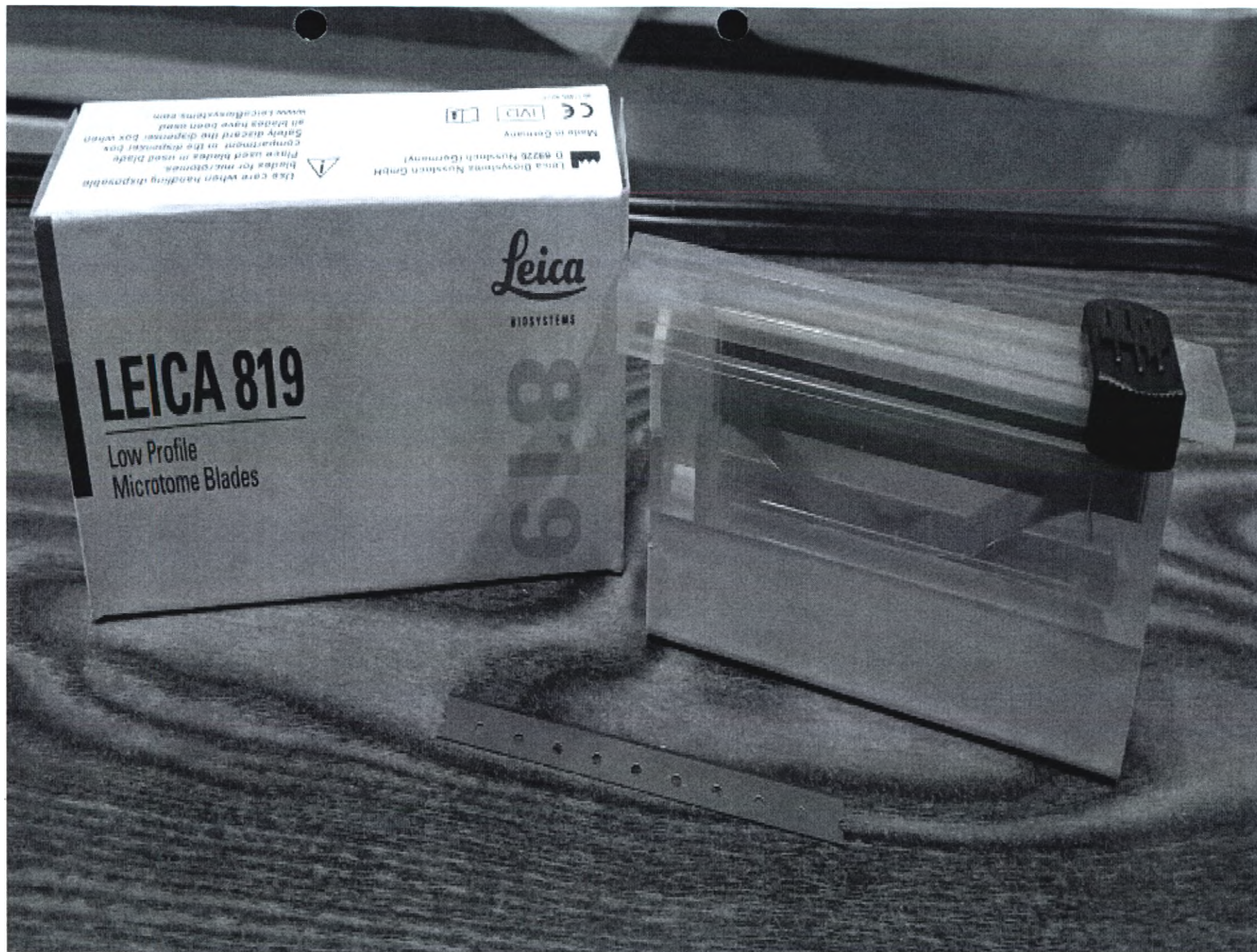
26. Лезвия одноразовые — низкого профиля (80 × 8 × 0,25 мм) (Disposable blades – low-profile)
