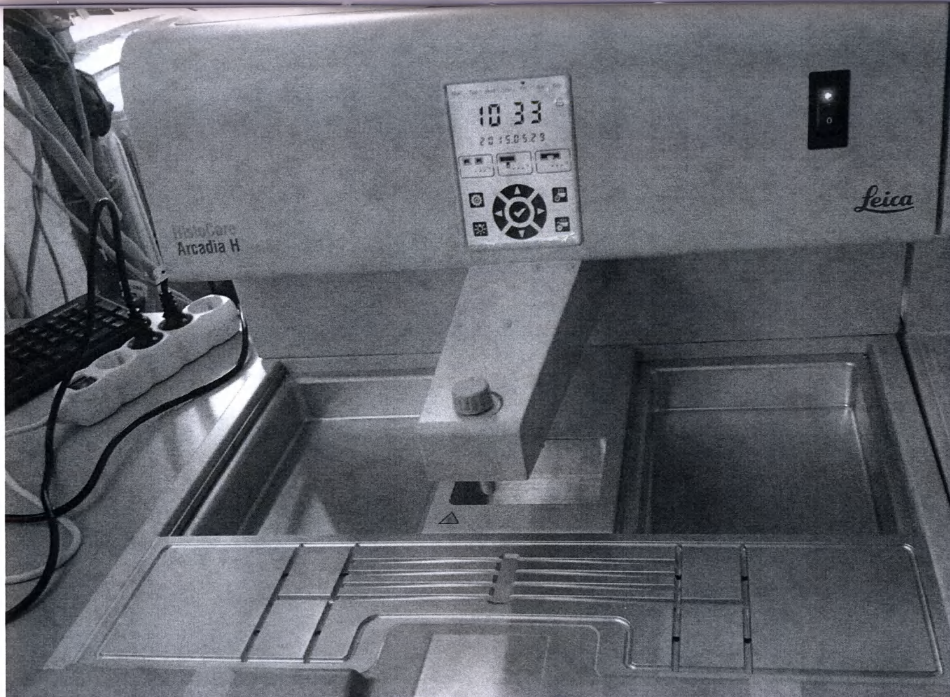
Рис. 20. Левый и правый поддоны, съемные (Left/right trays, removable), установленные в Базовый прибор HistoCore Arcadia H (Basic unit HistoCore Arcadia H).
