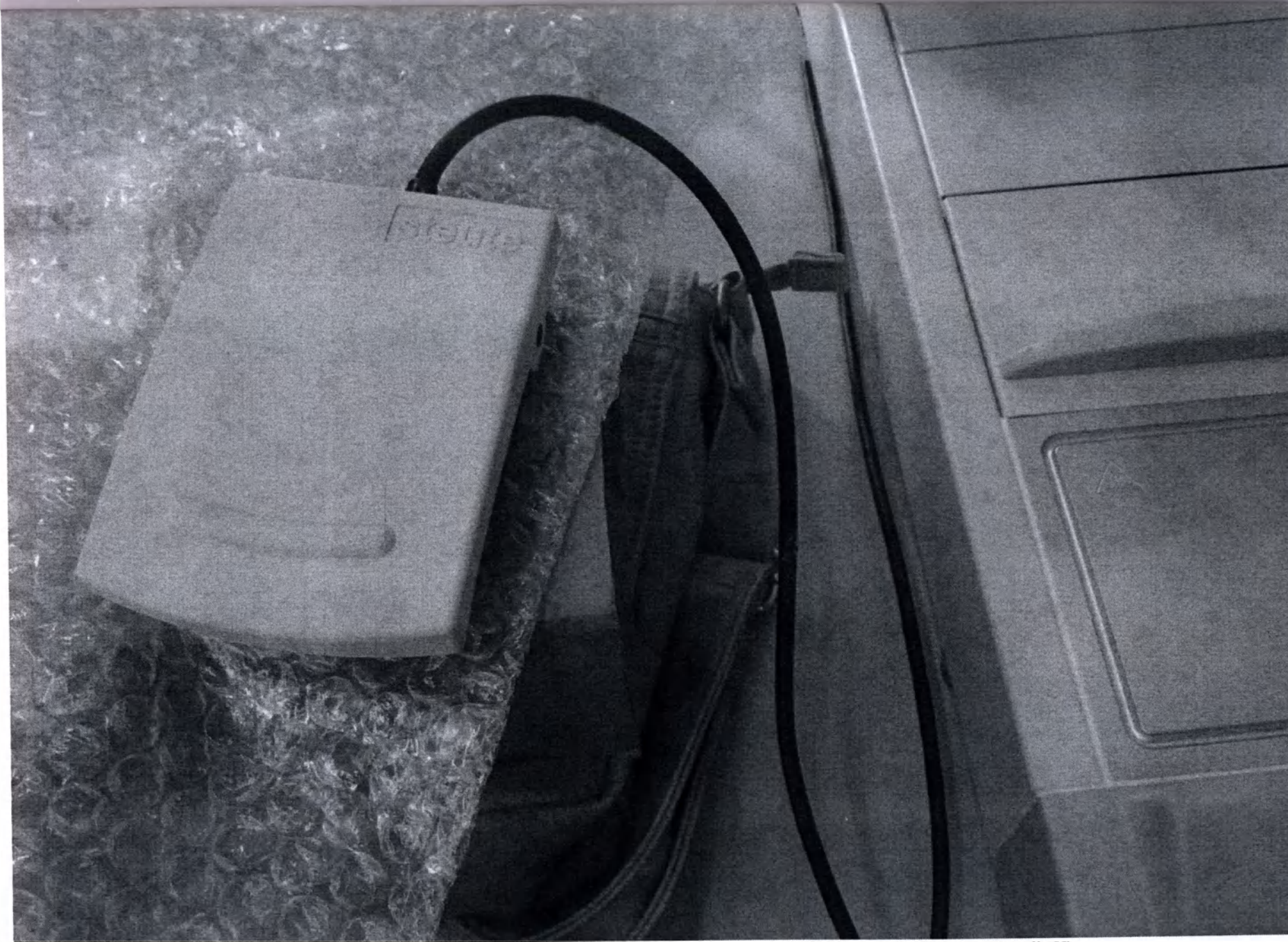
Рис. 43. Ножной переключатель (Foot switch), подключенный к Базовому прибору HistoCore Arcadia H (Basic unit HistoCore Arcadia H).
