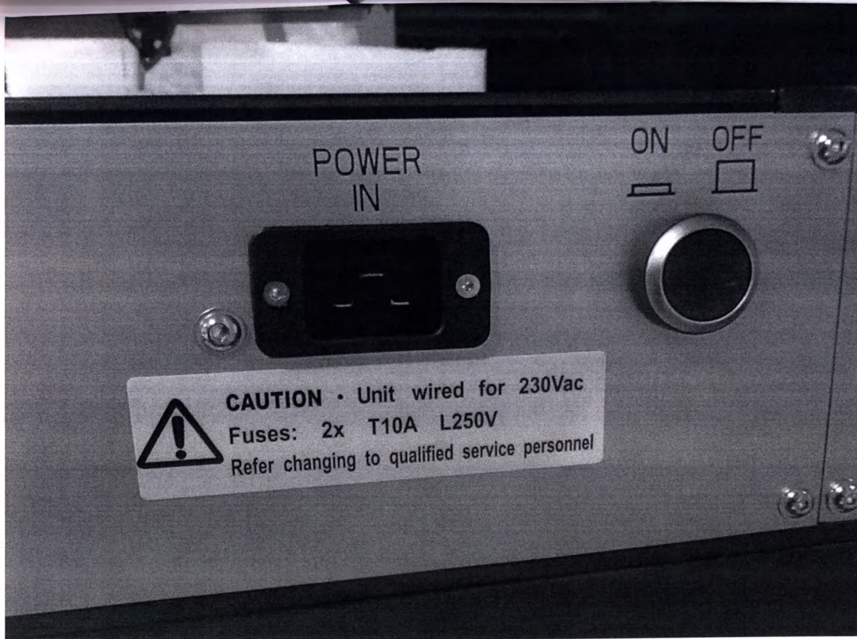
Рисунок 4 Задняя панель Гистопроцессора ASP6025 S (подключение к сети электропитания)
