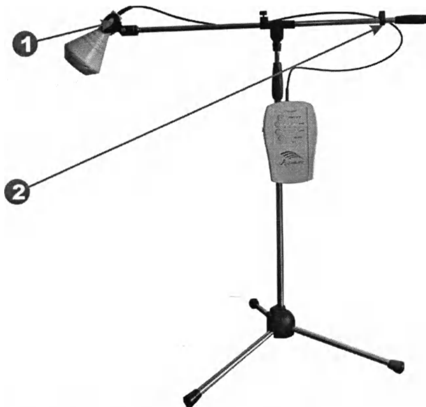
Рисунок 11. Установка антенны на стойку.
