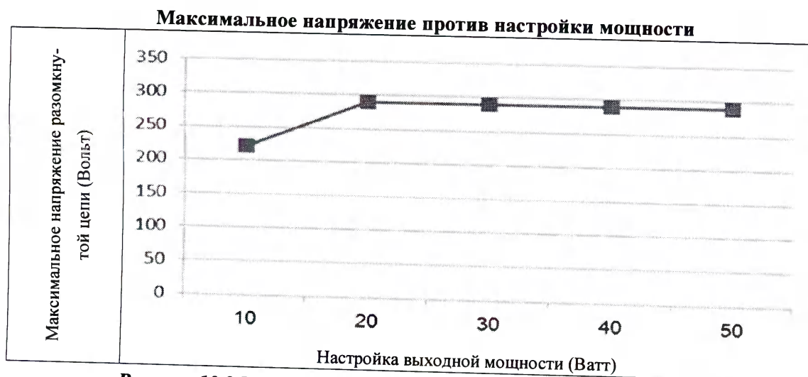
Рисунок 13.2 Максимальное напряжение против настройки мощности
