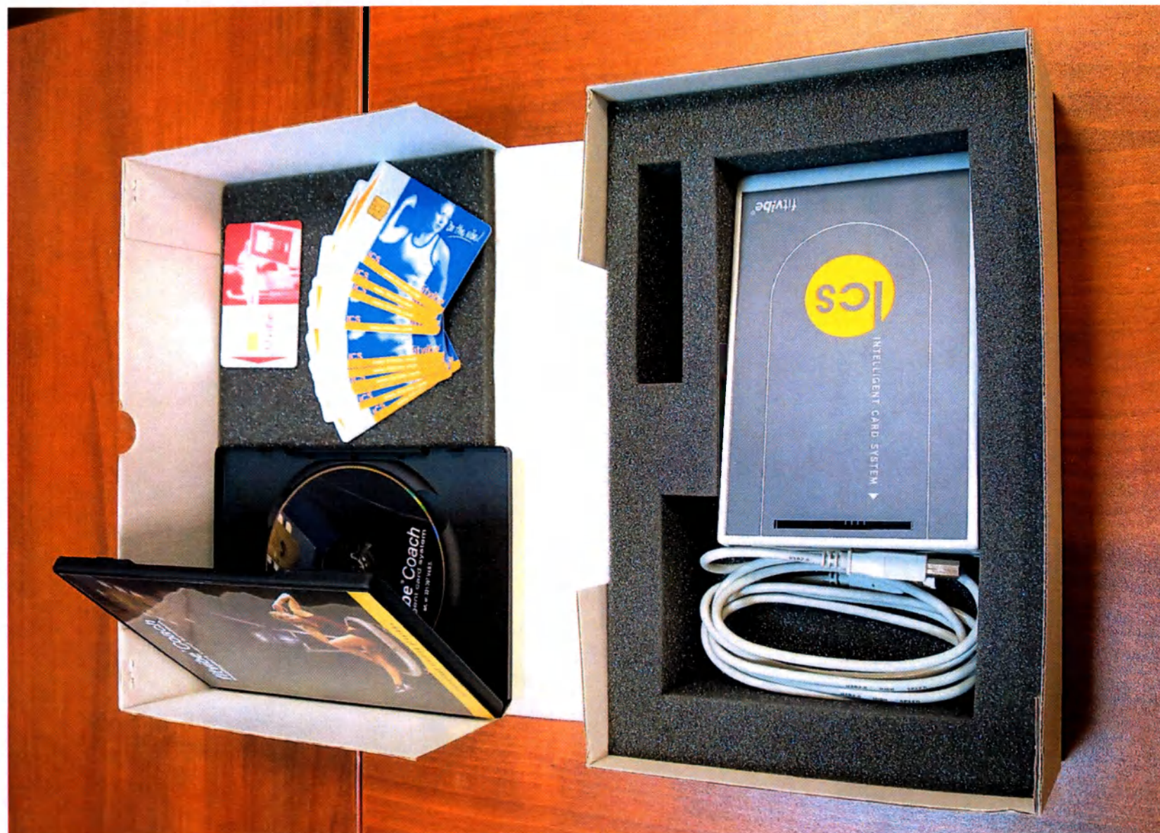
Рис. 14 Программатор карт памяти (включая 10 пластиковых карт пациента, 1 карточку настройки, установочный программный CD диск, USB соединитель)
