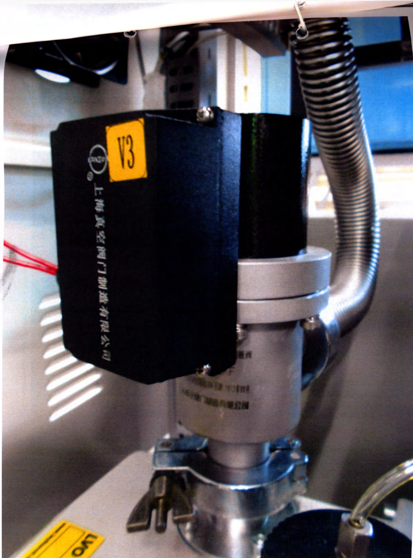
Электромагнитный вакуумный дроссельный клапан (Дроссельный клапан вакуумного насоса)
