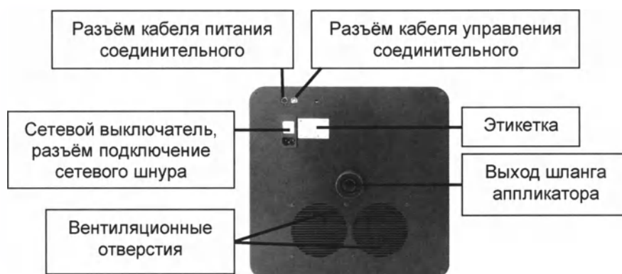
Рис. 2 Задняя панель тележки аппаратной при наличии встроенного контура регулировки температуры
