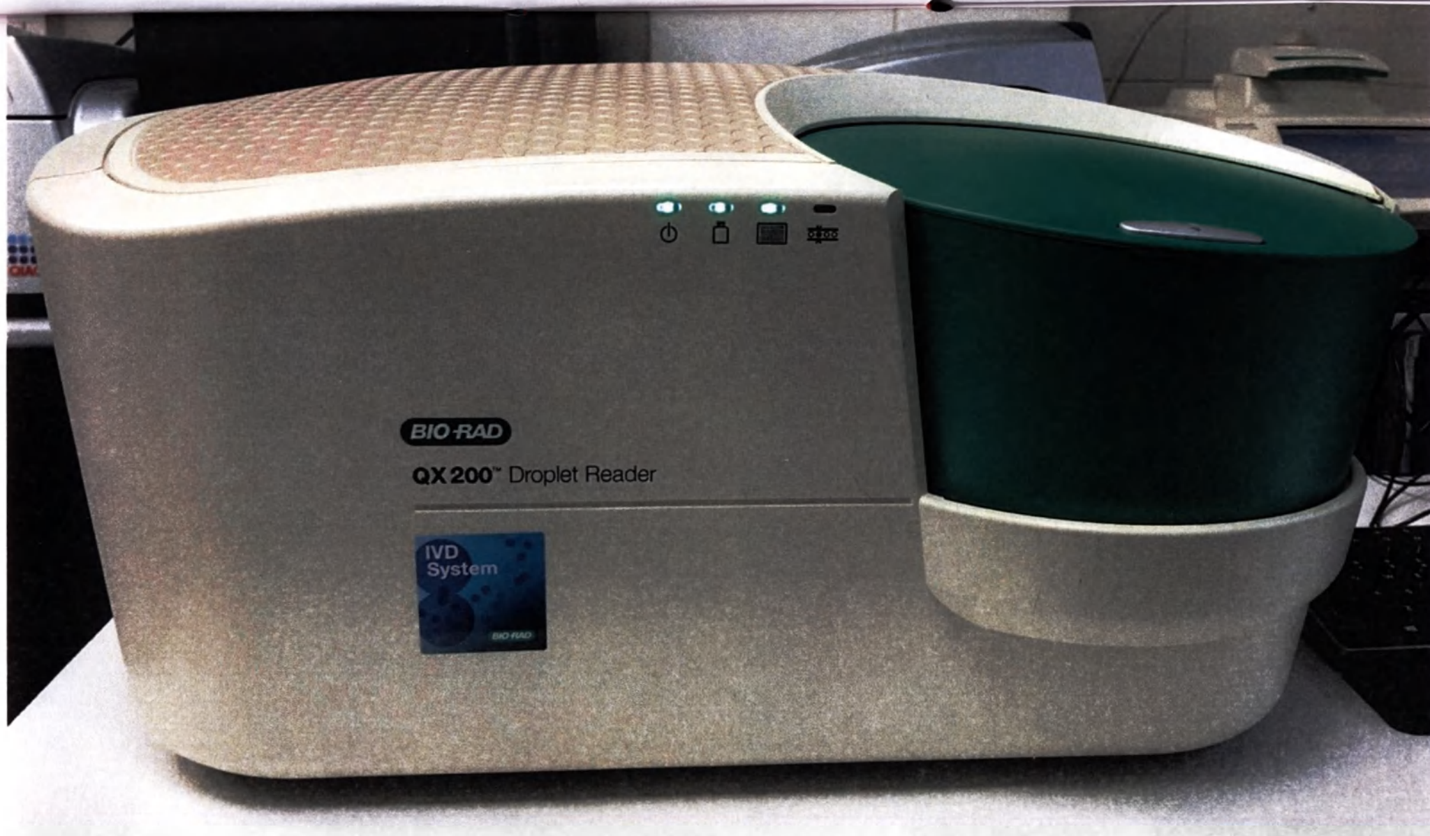
Рис. 1 Внешний вид «Ридер «QX200 Droplet Reader» для детекции флюоресценции капель в методе цифровой капельной ПЦР, с принадлежностями, в составе»
