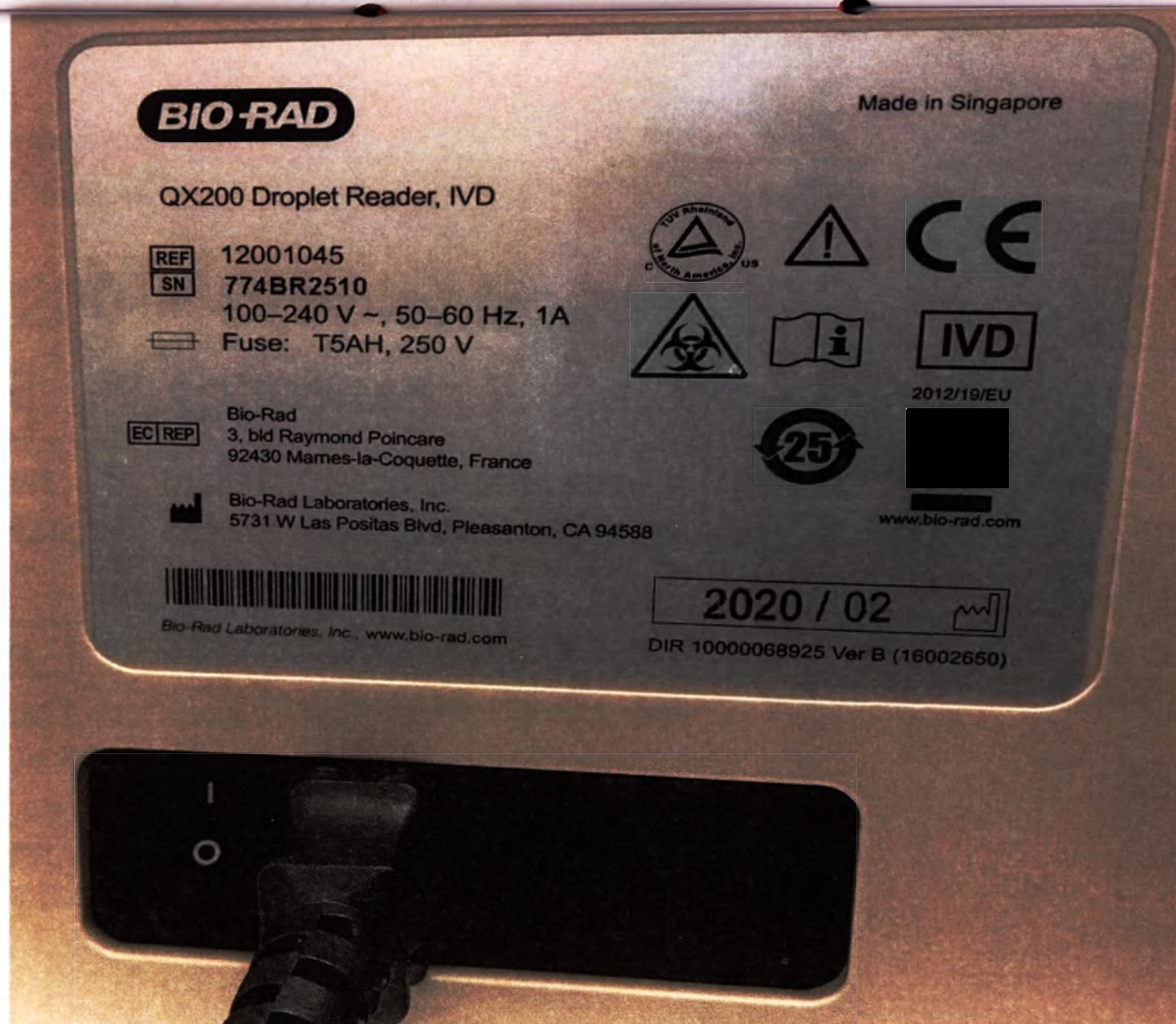
Рис. 3 Маркировка «Ридер «QX200 Droplet Reader» для детекции флюоресценции капель в методе цифровой капельной ПЦР, с принадлежностями, в составе»
