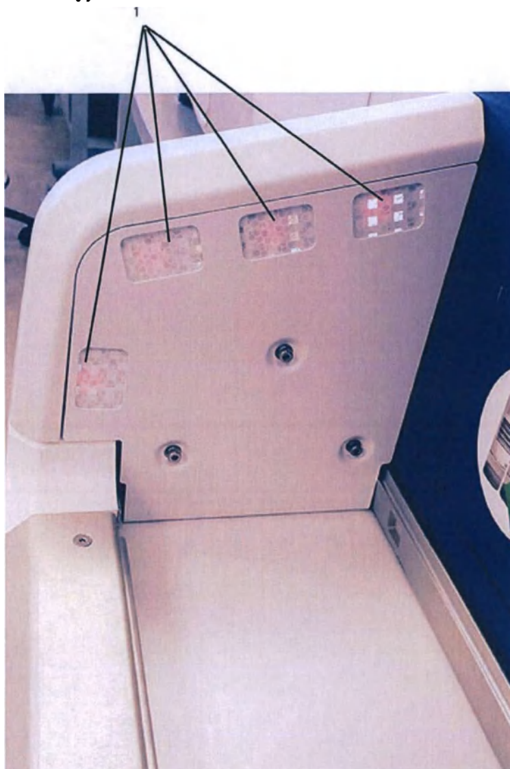
Рис. 21. Датчики световой завесы
