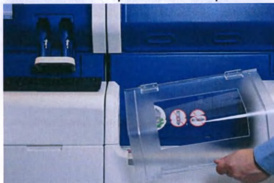
Рис. 128. Снятие крышки конвейера
