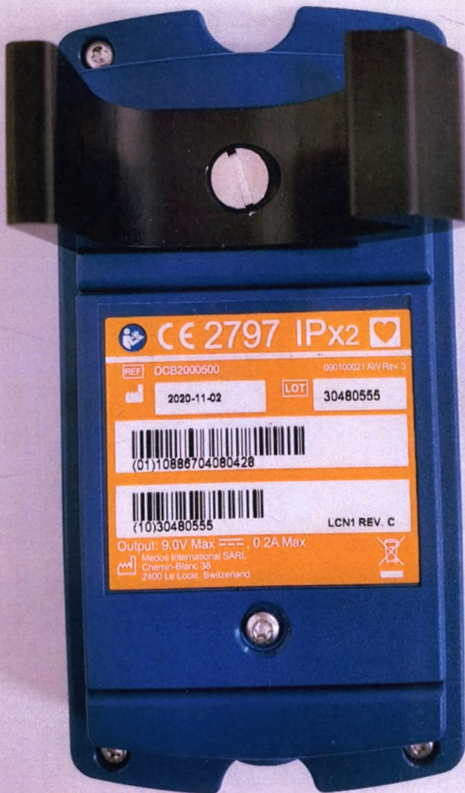
Рис 2. Устройство ENPOWER для отделения микроспиралей пример маркировки на устройстве
