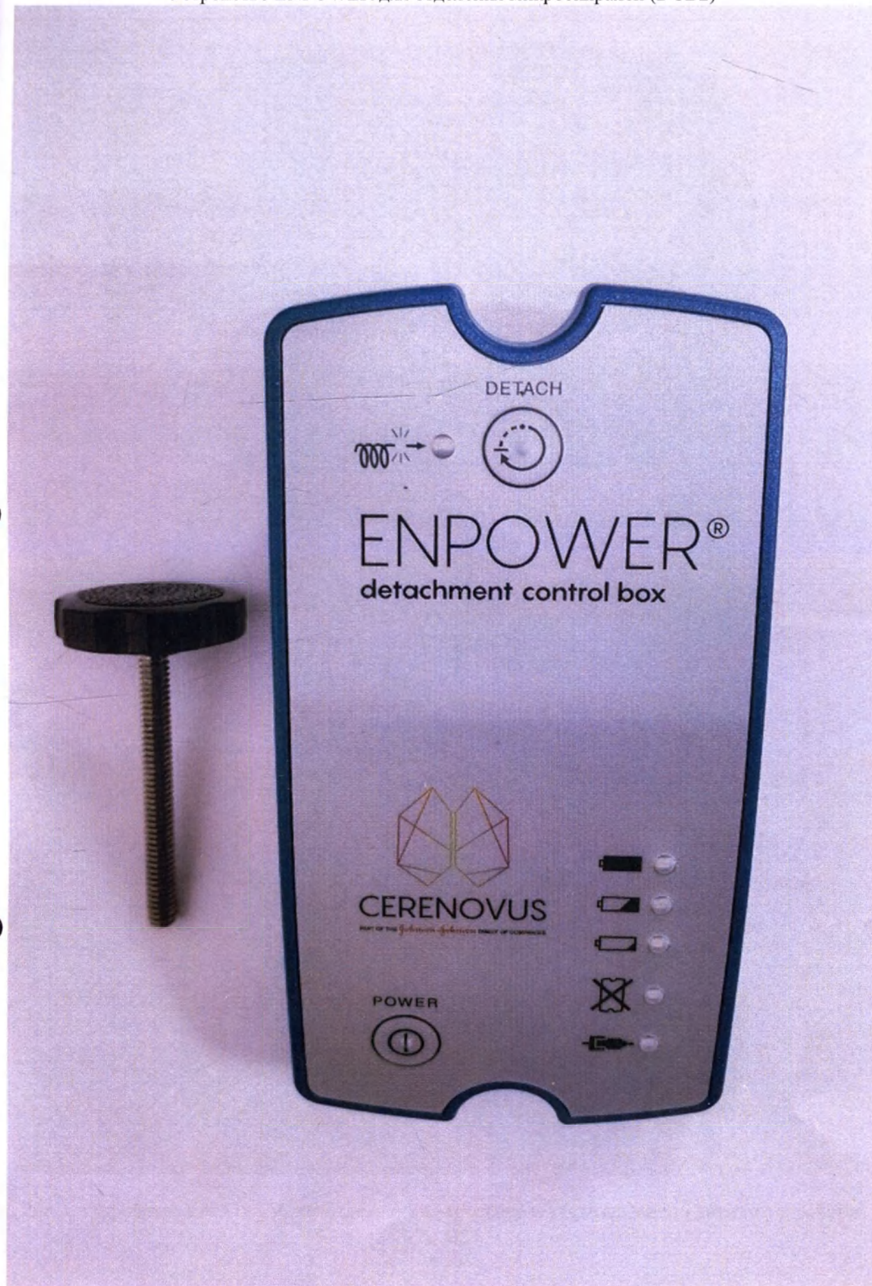
Рис 1 Устройство ENPOWER для отделения микроспиралей (DCB2). Внешний вид
