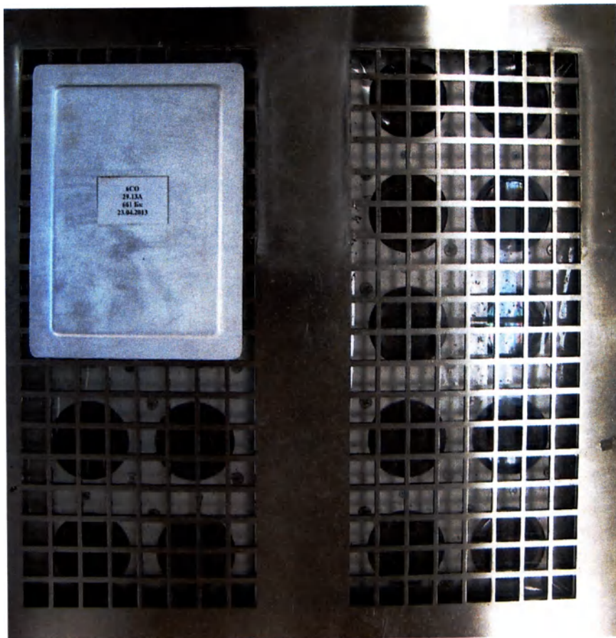
Рисунок 4.2а — Позиция «верх» источника типа 6С0 на устройстве детектирования «Нога»
