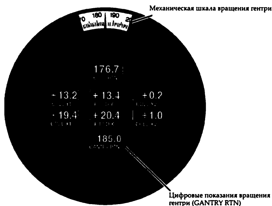
Рис. 31 Цифровой и механический дисплей положения гентри
