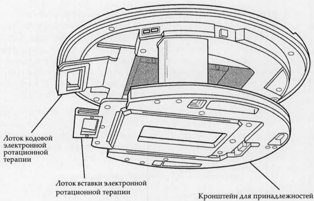
Рис. 96 Установленные лотки для электронной ротационной терапии
