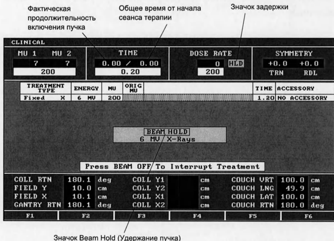
Рис. 13 Отображение двойного отсчета времени и значок задержки пучка
