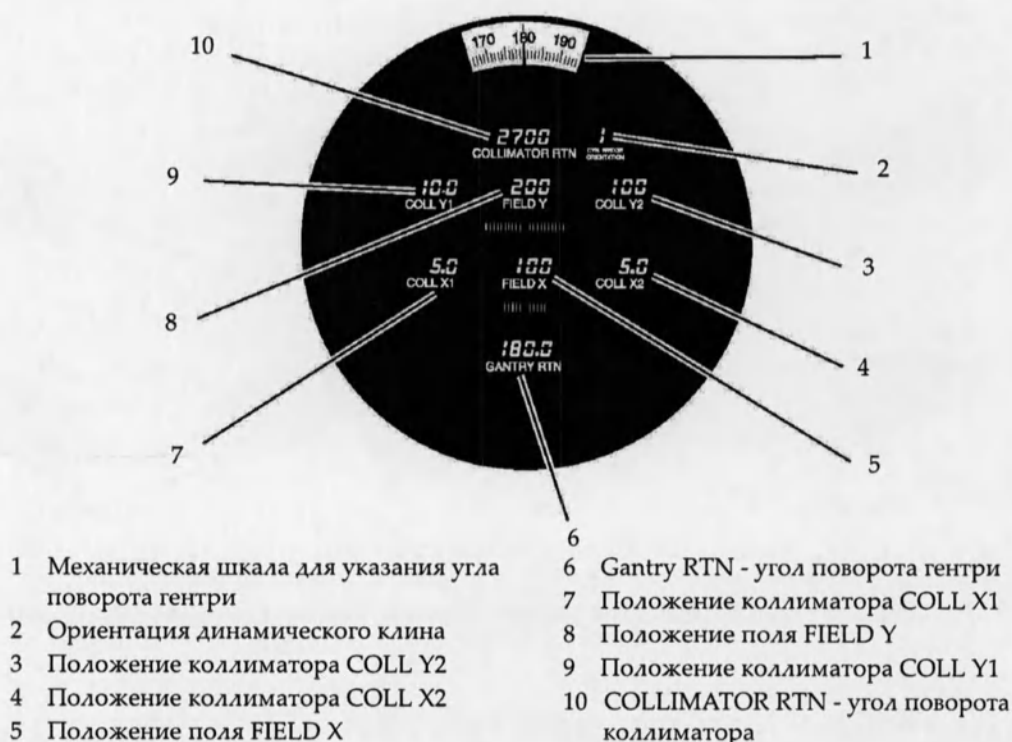
Рис. 8 Жидкокристаллический индикатор положения гентри
