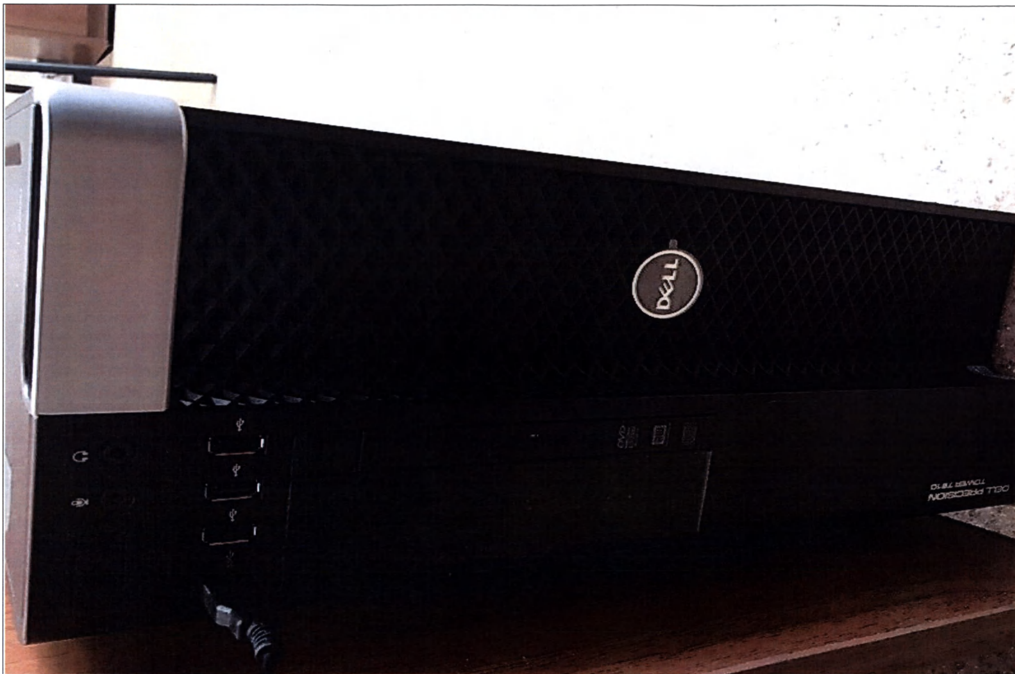
1.3b Рабочая станция для планирования лучевой терапии Eclipse с функцией резервного копирования в составе: Специализированное программное обеспечение для планирования лучевой терапии Eclipse; Процессор Dell Precision; Монитор NEC с диагональю 23 дюйма; Мышь Dell; Станция резервного копирования Dell; Клавиатура Dell; Операционная система
