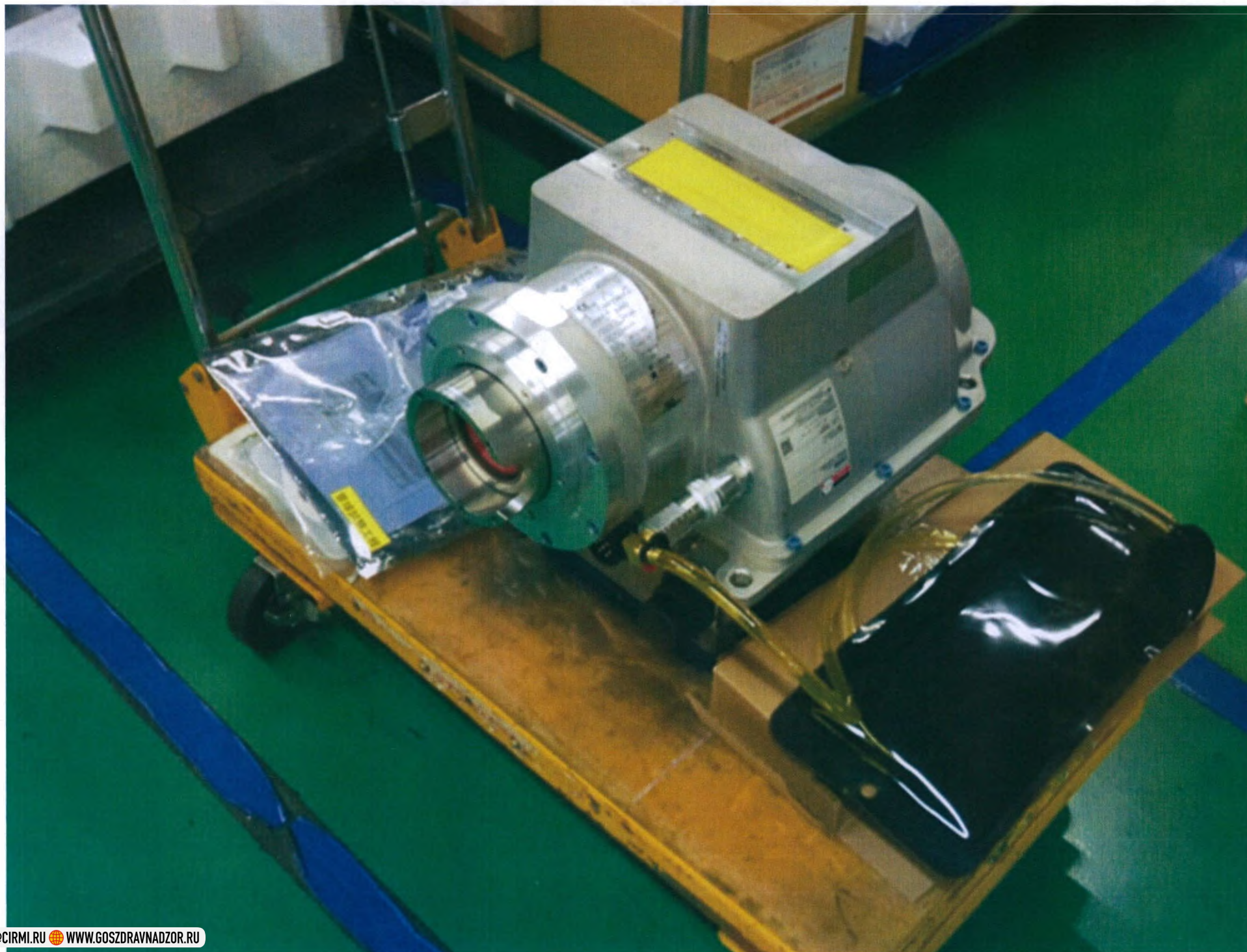
6. Рентгеновская трубка теплоёмкостью 7,5 млн ТЕ, производства Varex Imaging Corporation, США.
