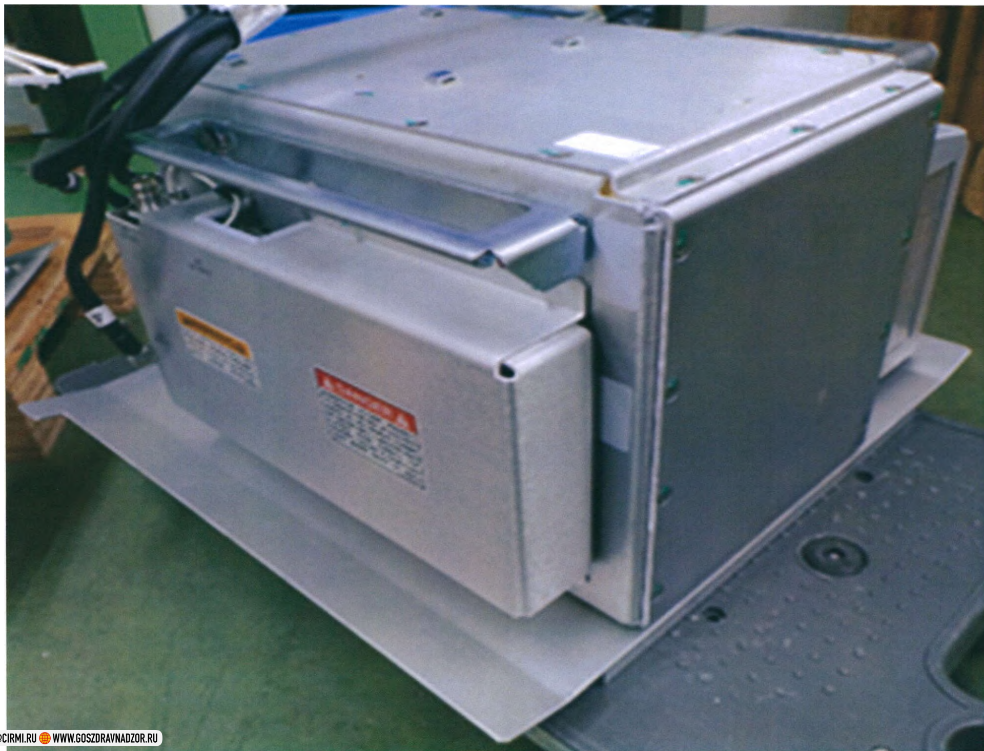
126. Модуль модернизации рентгеновской трубки и генератора (изображение генератора (HV))
