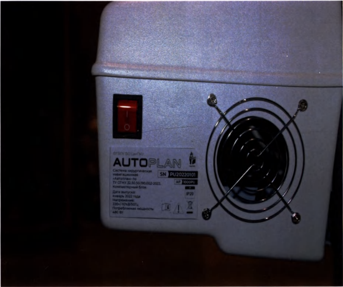
Рисунок 16 . Маркировка компьютерного блока.
