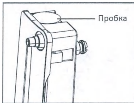
Рис. 13 – Извлечение увлажнителя и место наполнения его водой
