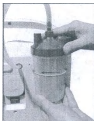
Рис. 35 – Извлечение увлажнителя и место наполнения его водой
