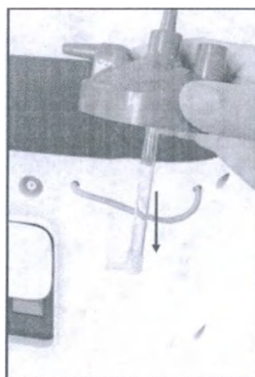
Рис. 21 – Извлечение увлажнителя и место наполнения его водой
