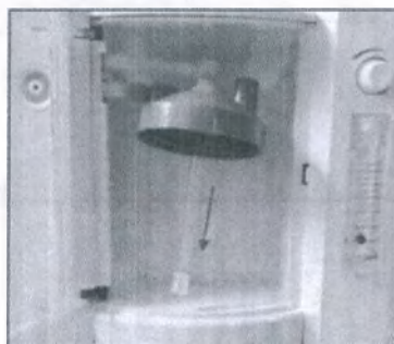
Рис. 41 – Извлечение увлажнителя и место наполнения его водой
