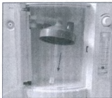
Рис. 62 – Извлечение увлажнителя и место наполнения его водой
