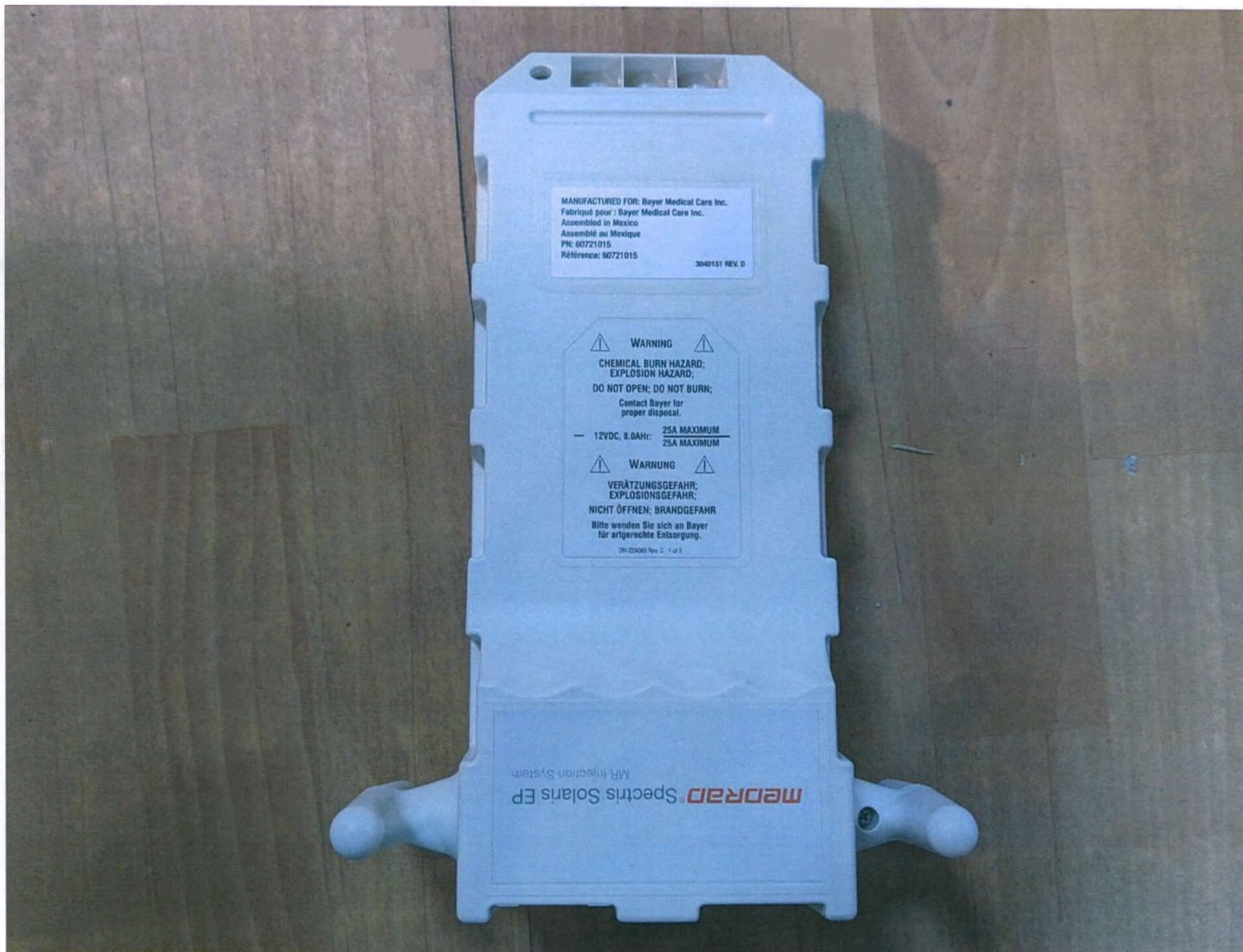
Рис. 12. Базовый состав: 4. Батарея аккумуляторная
