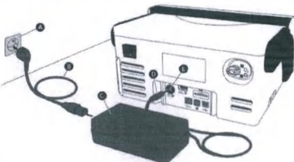
Рис.: Подключение к сети через блок питания
