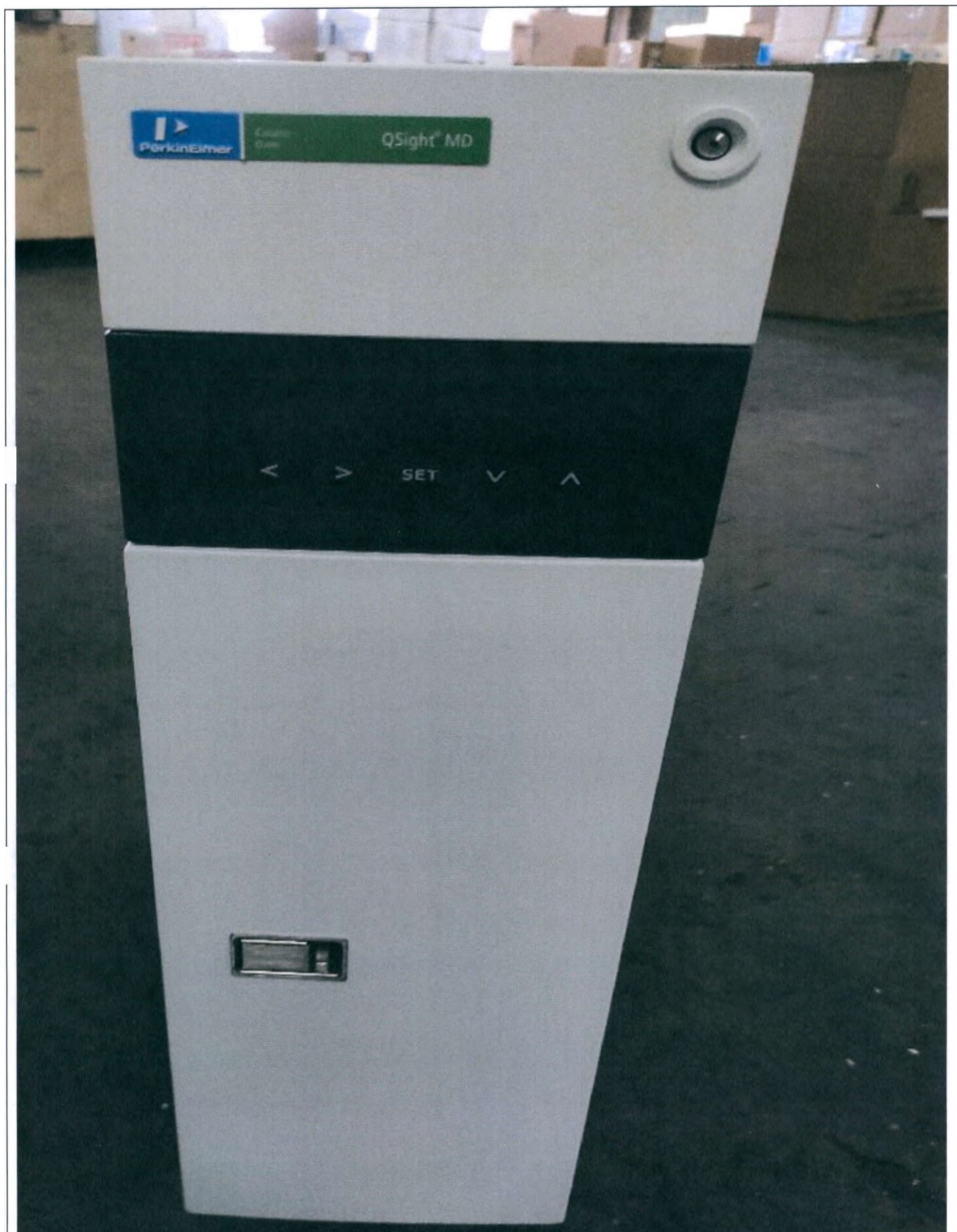
4. Колоночный термостат QSight MD (QSight Column Oven MD)
