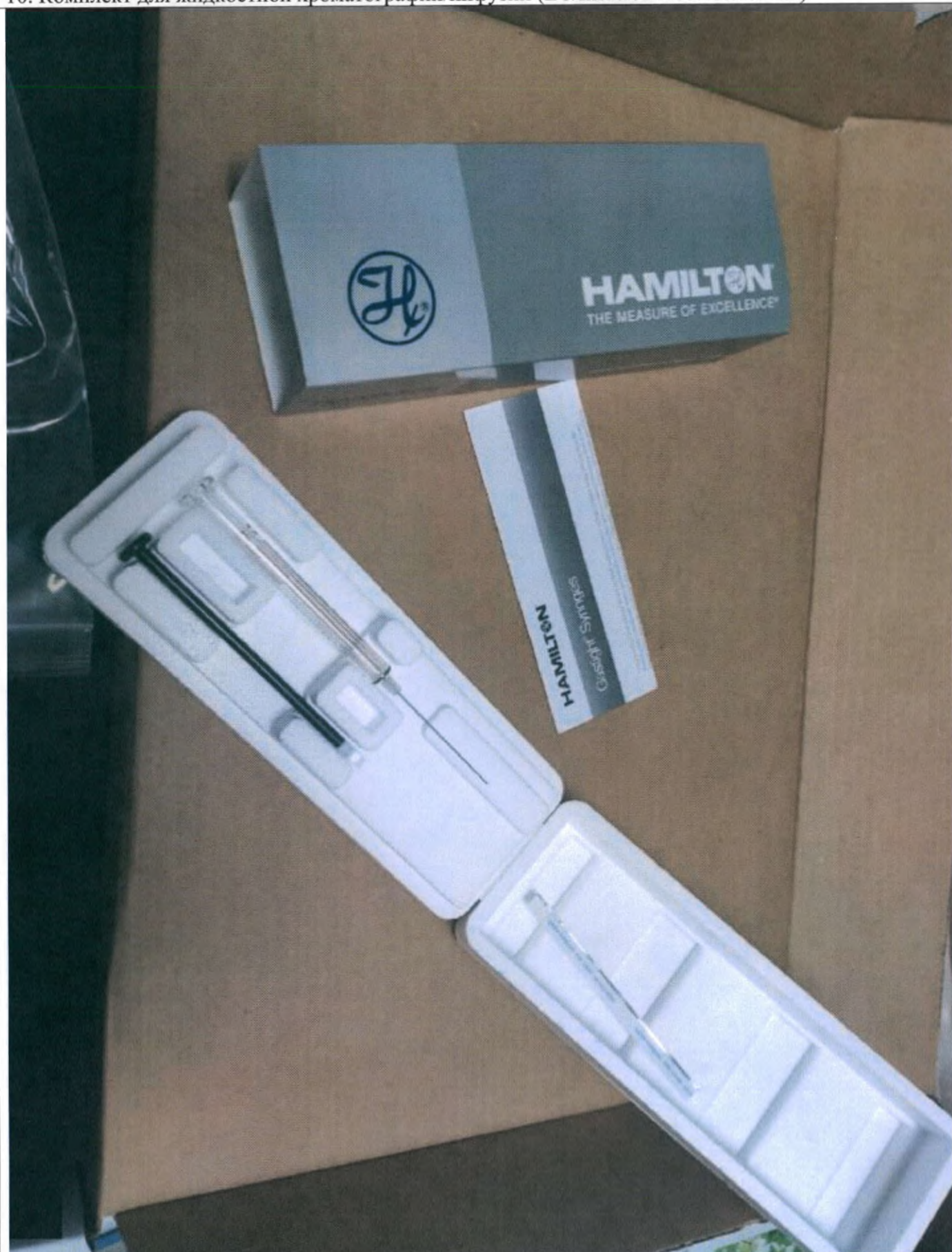
10.1 Шприц, объемом 1 мл с фиксированным наконечником, Hamilton (Syringe, 1 mL Fixed Tip, Hamilton)
