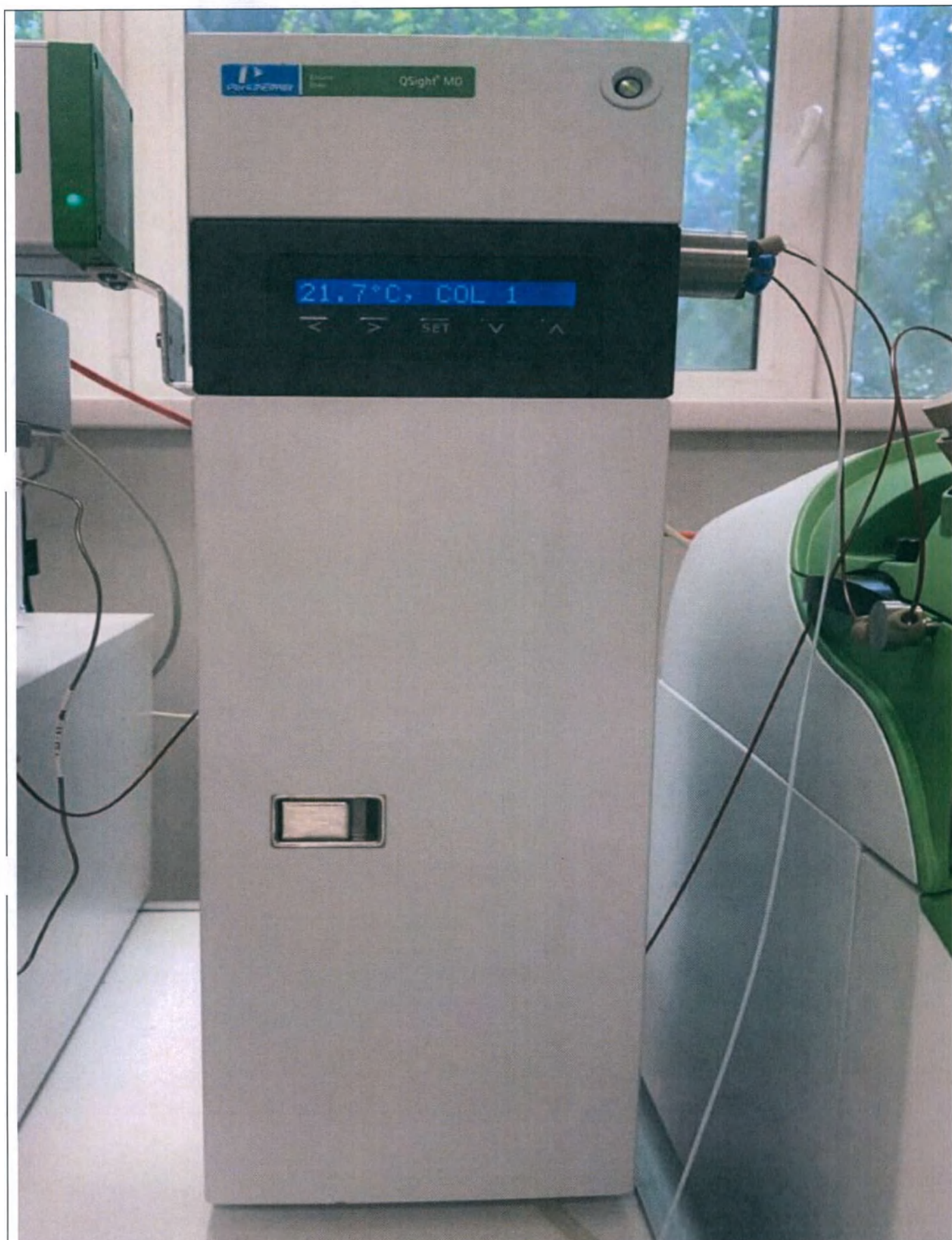
4. Колоночный термостат QSiht MD (QSiht Column Oven MD)
