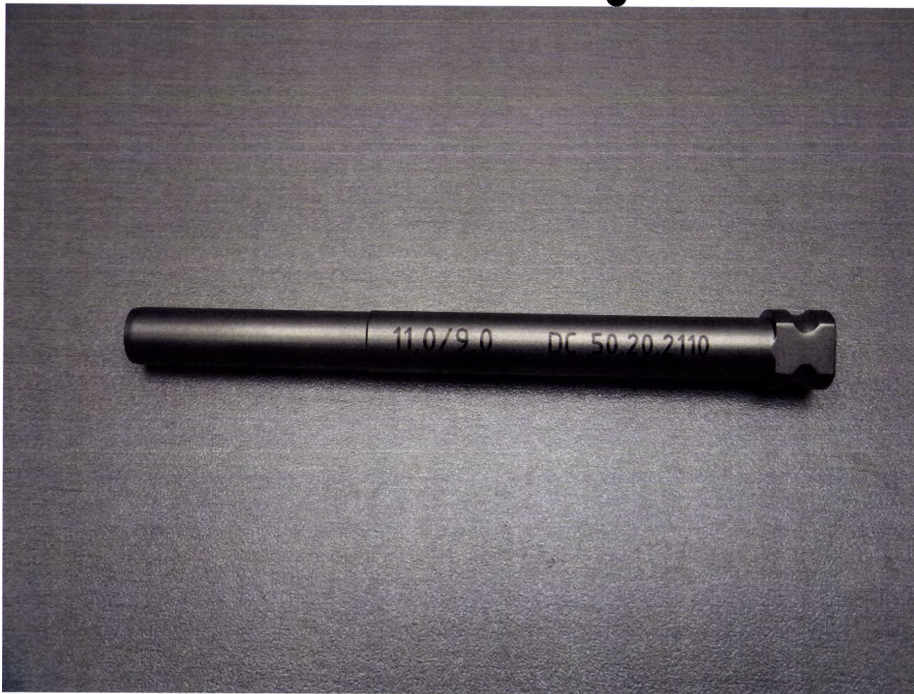
Рисунок 26 – Направитель 11,0/9,0, № 50.20.2110. Внешний вид идентичен также для вариантов исполнения: № 50.20.2060. Отличие только в размерах.
