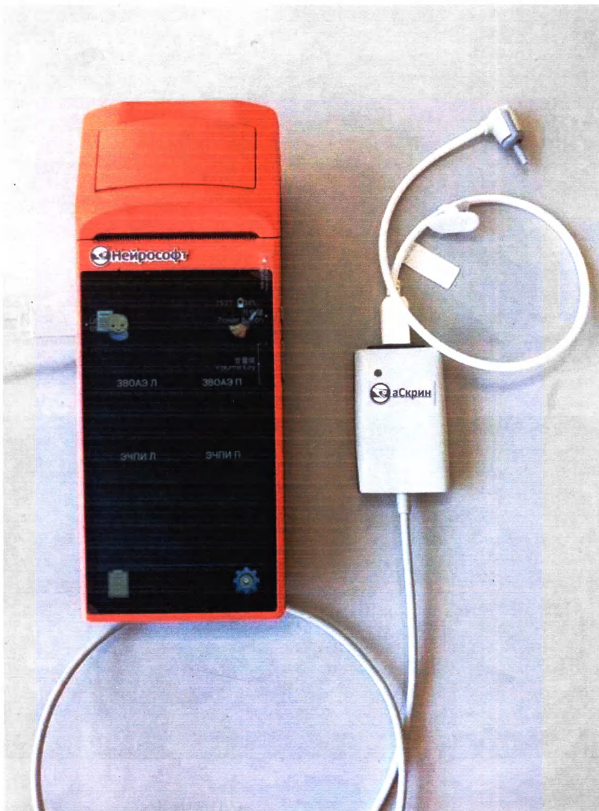
Общий вид: блок электронный «аСкрин» в сборе с зондом ОАЭ «ОАЭ-05» и мобильным терминалом NS093201.004
