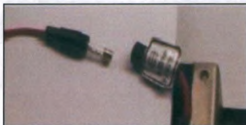
Рисунок 61 Предохранитель резервной батареи
