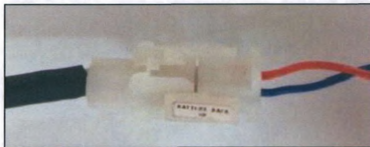
Рисунок 74 Разъем резервной батареи [Черный - от резервной батареи. Темно-синий/оранжевый - от жгута проводов ТЕС 3000]
