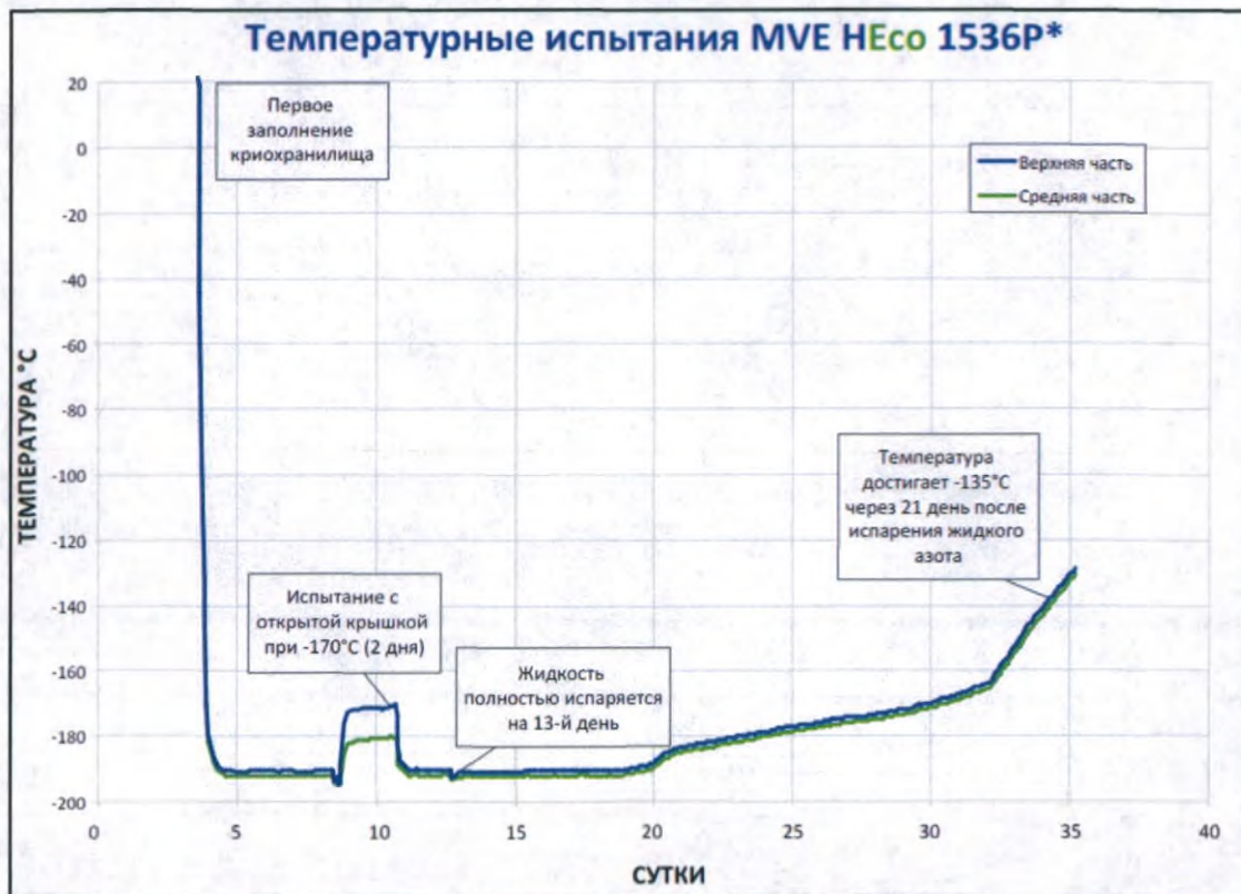
Рисунок 6 График температурных испытаний 800-х и 1500-х моделей криобиологического морозильного аппарата MVE HEco Series
