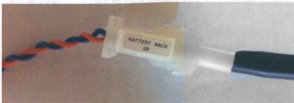
Рисунок 63 Разъем резервной батареи [черный — от резервной батареи. Темно-синий/оранжевый — от жгута проводов ТЕС 3000]
