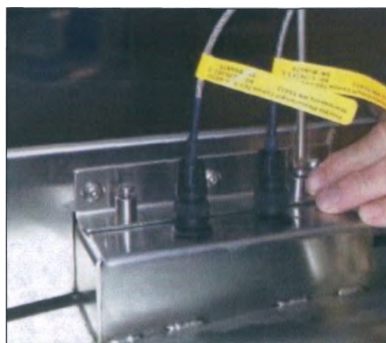
Рисунок 68 Болты с крестообразным шлицем, которые необходимо удалить
