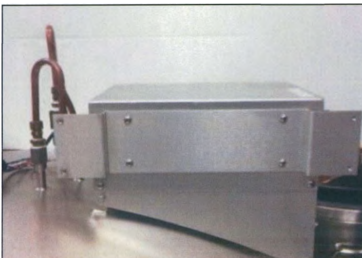
Рисунок 60 Установленный кронштейн для резервной батареи
