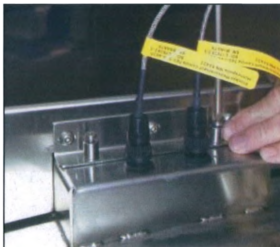
Рисунок 72 Болты с крестообразным шлицем, которые необходимо удалить
