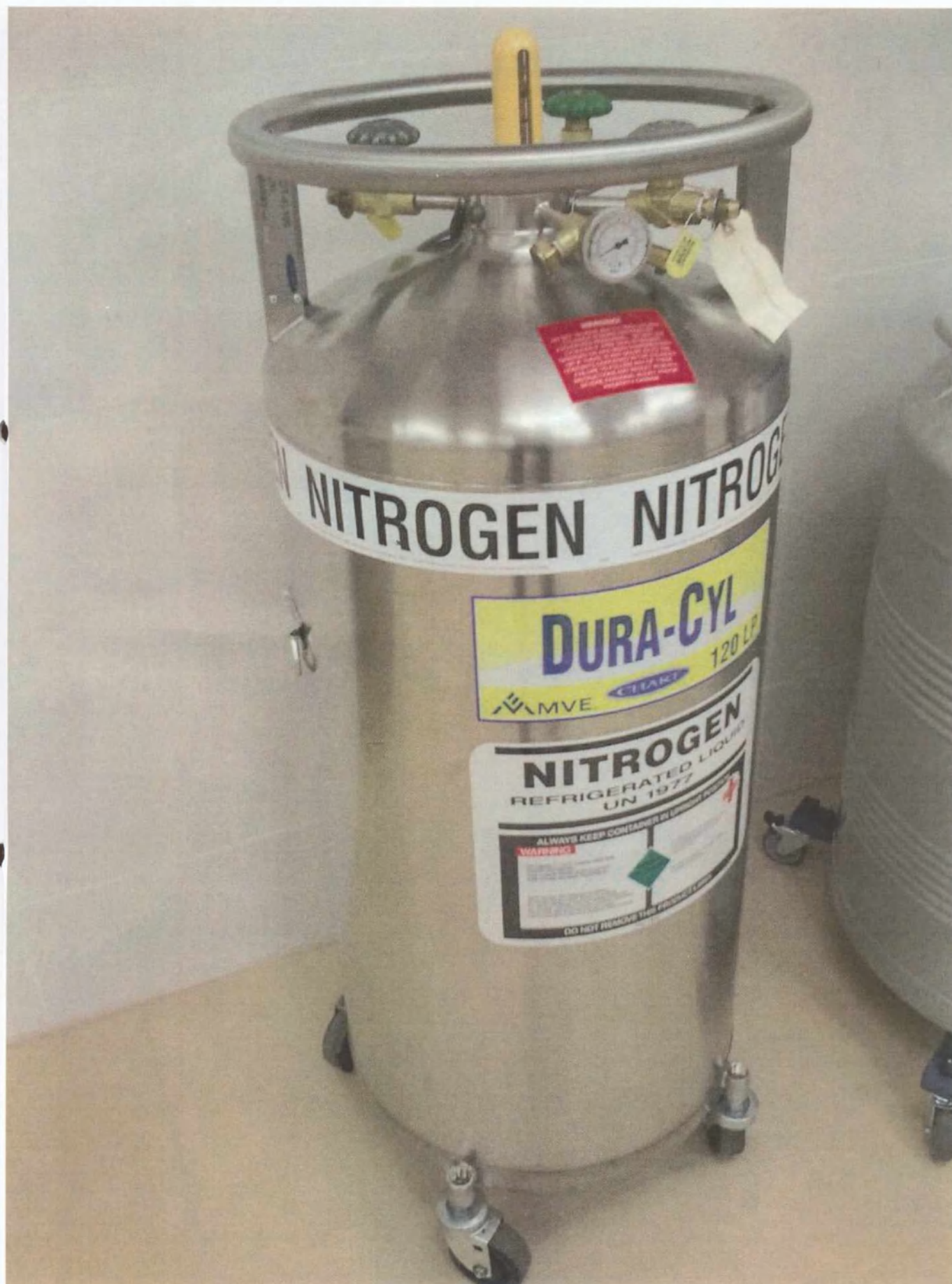
Резервуар для подачи жидкого азота в MVE замораживатель
