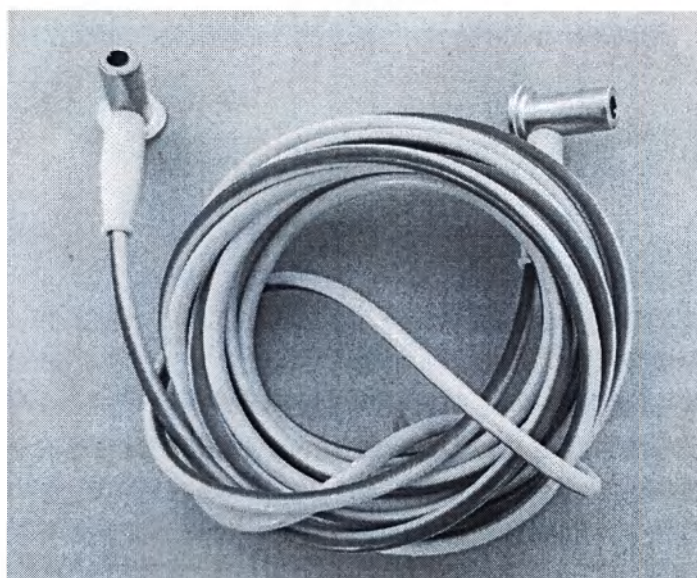
Рисунок 6 – Внешний вид кабеля заземления.
