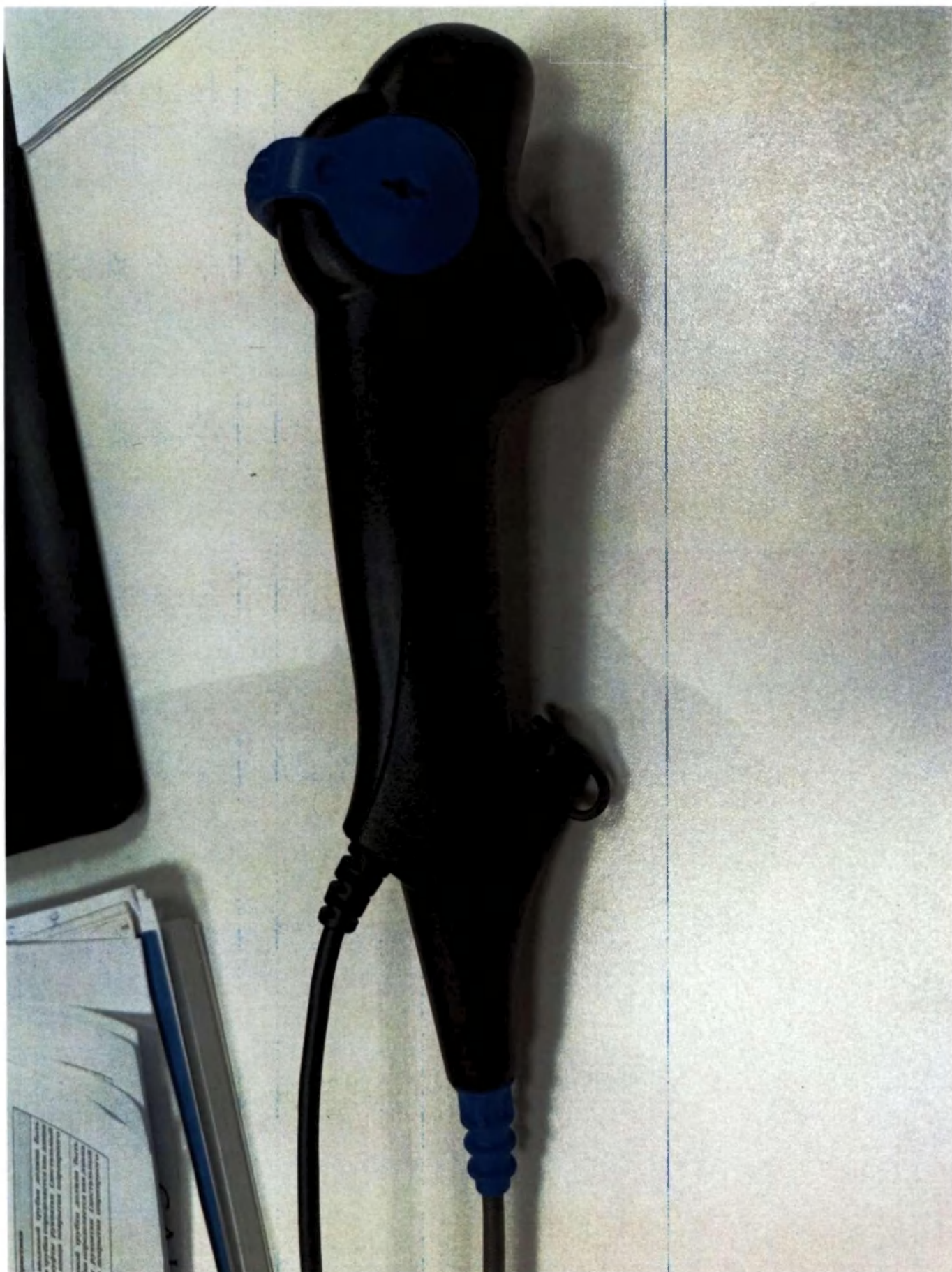
Бронхоскоп для одноразового применения EXALT Model B, средний, внешний диаметр 5,0 мм, средний внутренний диаметр рабочего канала 2,2 мм – Рукоятка, сторона 1
