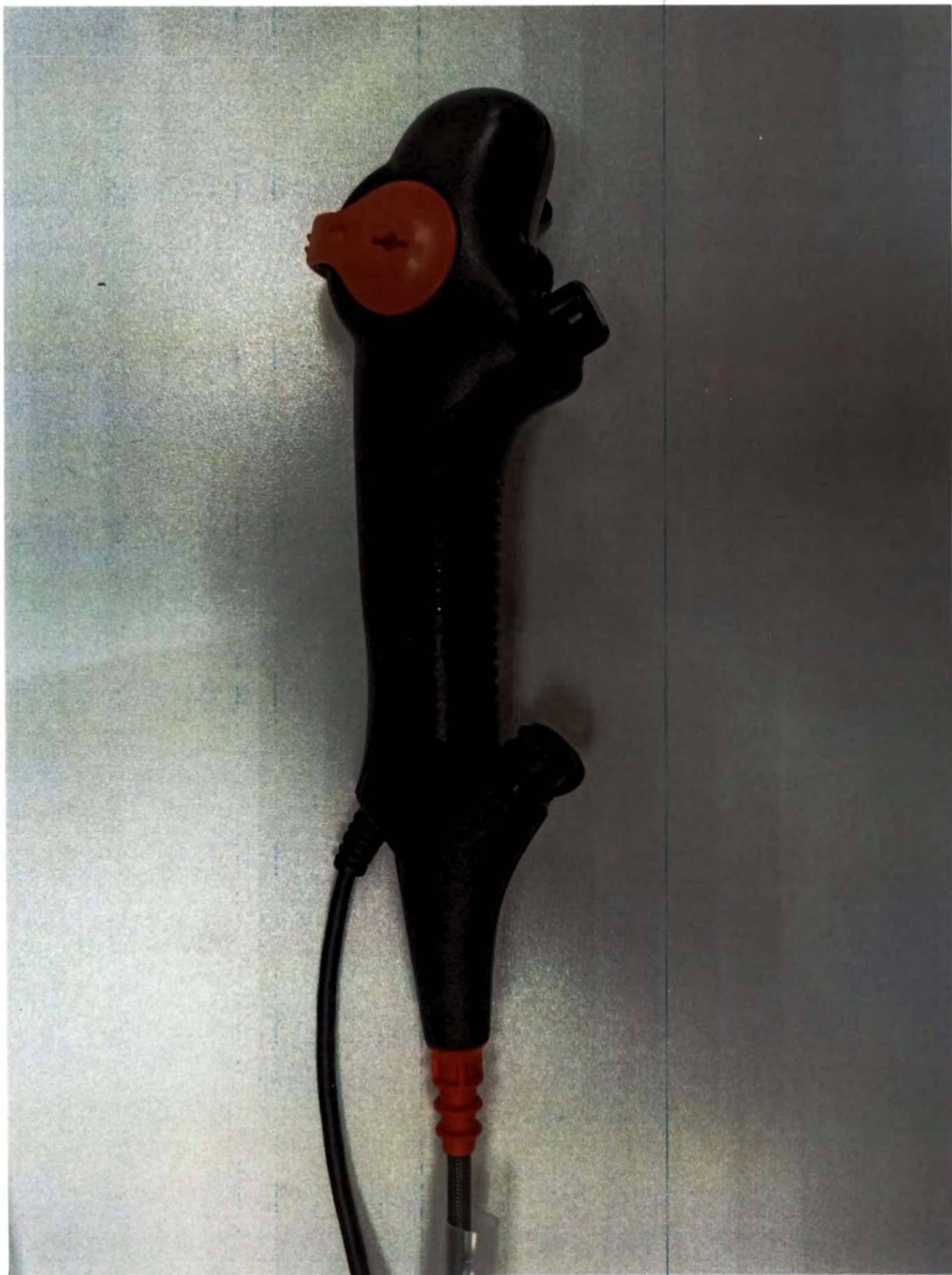
Бронхоскоп для одноразового применения EXALT Model B, большой, внешний диаметр 5,8 мм, средний внутренний диаметр рабочего канала 2,8 мм – Рукоятка бронхоскопа, сторона 1
