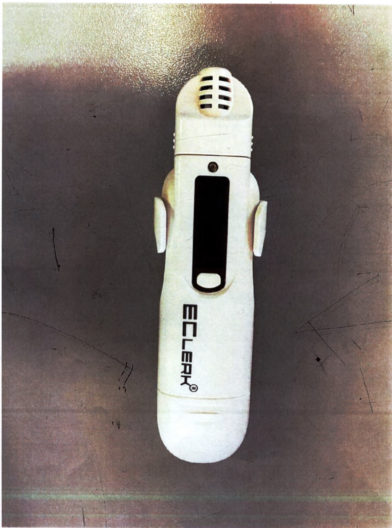
Измеритель-регистратор температуры (терморегистратор)
