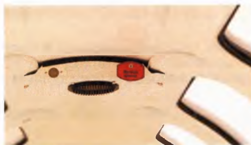
Клавиша «Вызов врача» внутри бароаппарата
