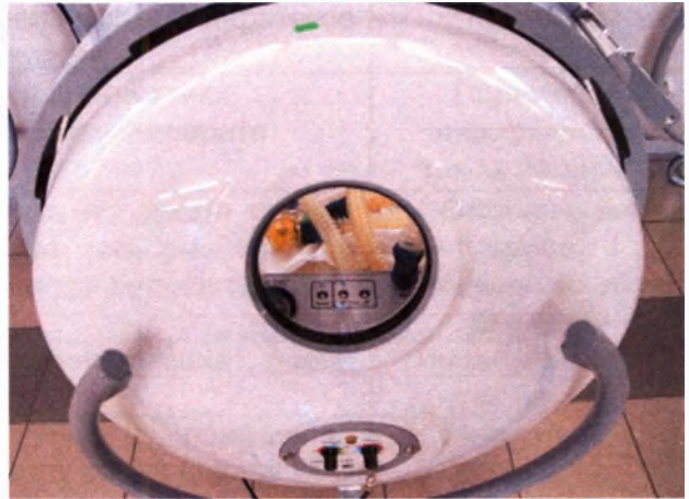
Монтаж аппарата «ИВЛ БЛКС» на крышке бароаппарата
