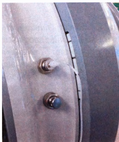
Подсоединение штуцера через гермоввод
