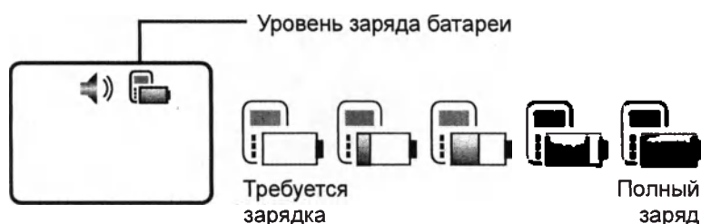
Рис. 4.1 Экран и значки уровня заряда батареи зарядного устройства.
