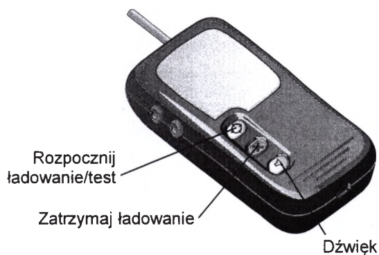
Rysunek 1.3 Przyciski ładowarki.
