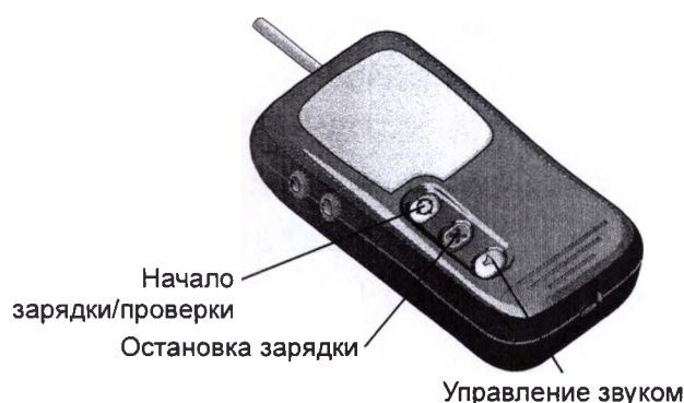
Рис. 1.3 Кнопки зарядного устройства.
