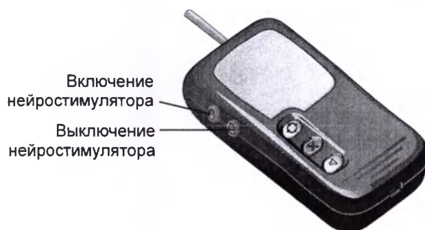
Рис. 2.10 Кнопки включения и выключения нейростимулятора.
