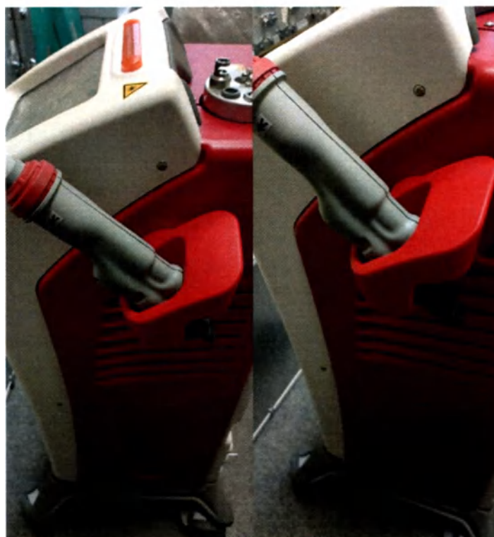
Рисунок 20 – установка держателя насадки
