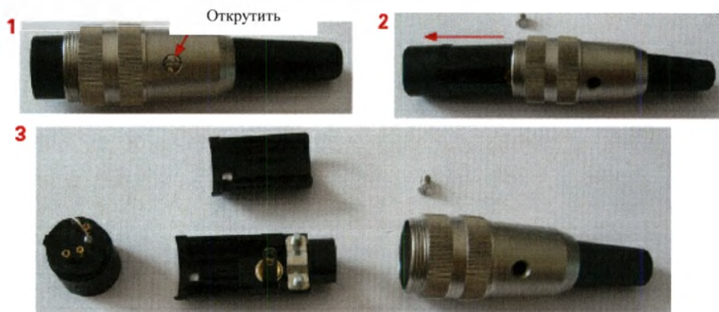
Рисунок 21 – Как открыть разъем блокировки двери
