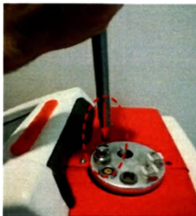
Рисунок 18 – установка держателя оптоволоконна
