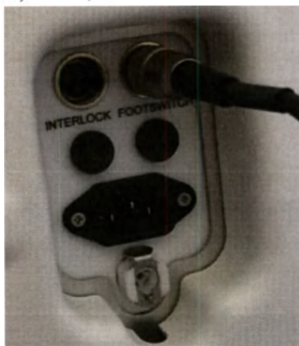
Рисунок 16 – Установка педального переключателя
