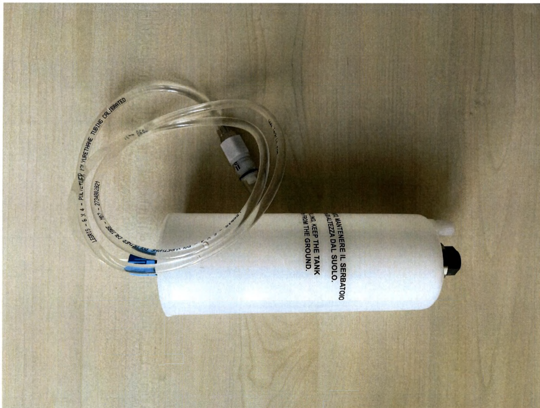
Фото 32 - Ёмкость заправочная с охлаждающей жидкостью
