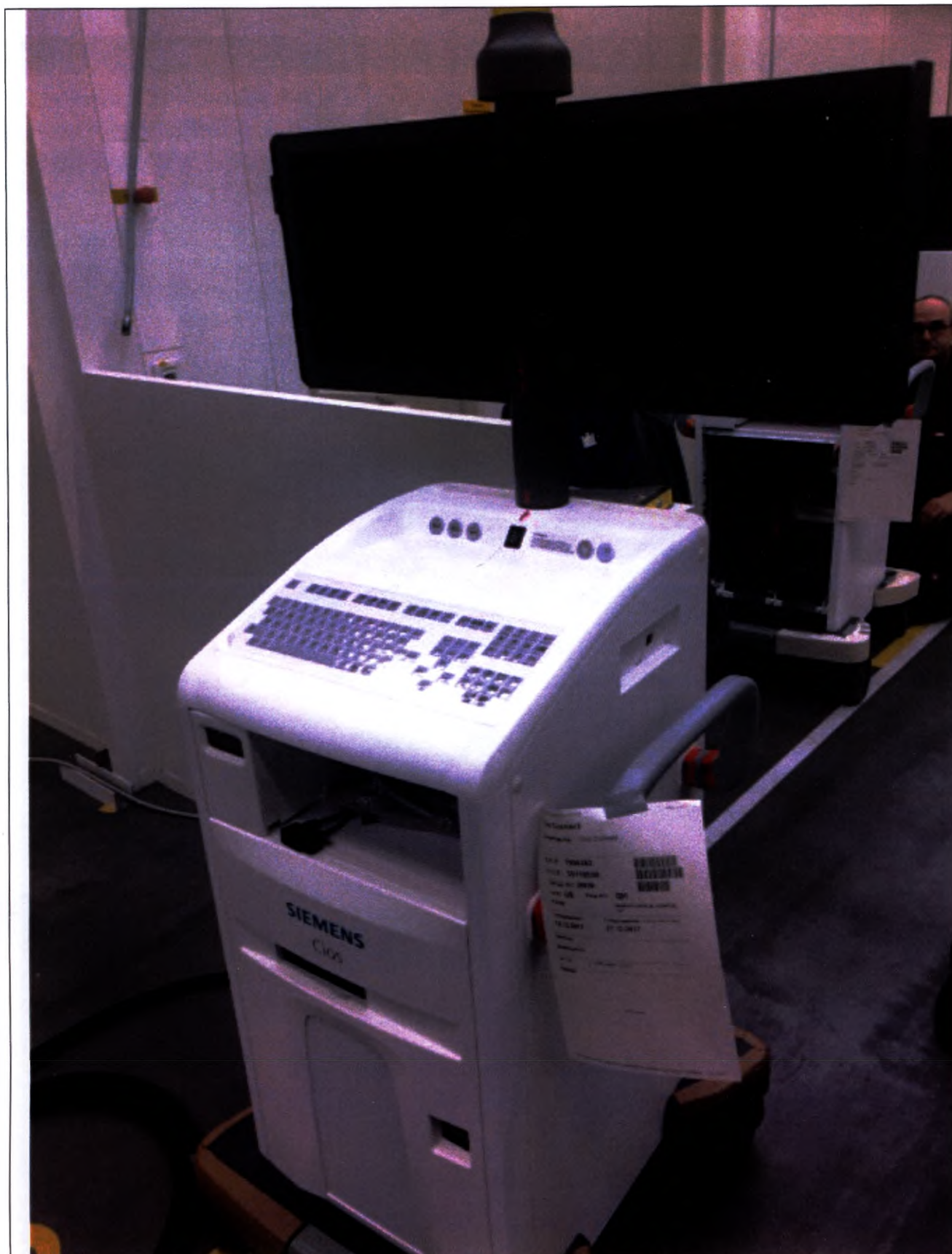
2.1 Мониторная стойка, в составе: штатив мониторов, варианты исполнения стойка дисплея Flex или стойка дисплея Flex Plus; панель управления с клавиатурой; мышь; монитор; порт USB; дисковод для дисков DVD.
