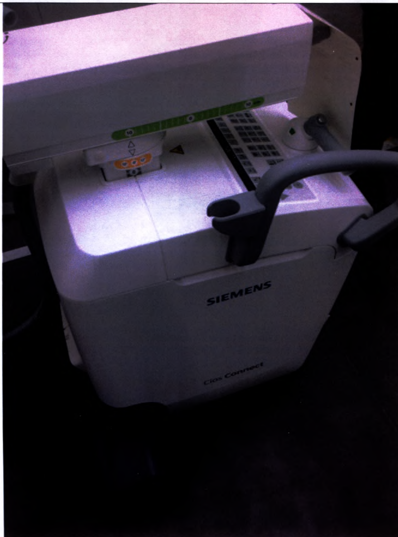
1.2 Аппарат передвижной рентгеновский С-дуга «Cios Connect», в составе: С-образная дуга; генератор рентгеновский; трубка рентгеновская со встроенным коллиматором; усилитель рентгеновского изображения; панель управления с клавиатурой.
