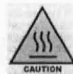
Осторожно! Горячая поверхность
