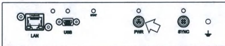
Рисунок 2.1 – Разъем питания детектора на панели разъемов детектора формата 12×15 см
