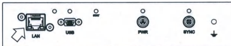
Рисунок 2.4 – Разъем подключения детектора и АРМ лаборанта на панели разъемов детектора формата 12×15 см
