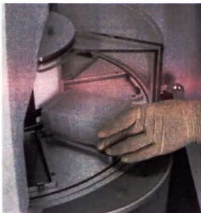
Рисунок 9 – Установка глубоколоуночного планшета
