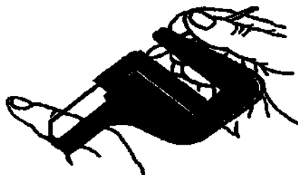
Рис. 5. Установка скобок в пазы.
