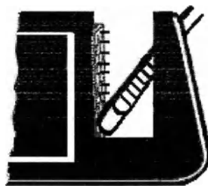
Рисунок 7. Утапливание скобок в пазы магазина
