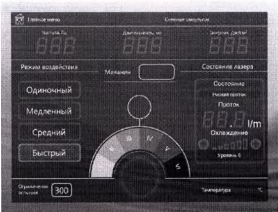
Рис. 15 Неисправность датчика протока или системы охлаждения
