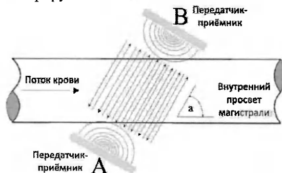
Рисунок 27 – Схема работы принципа Доплера
