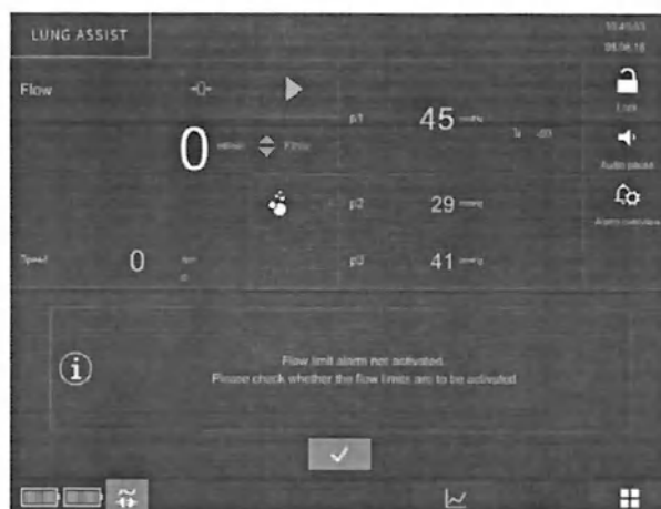
Рисунок 128 – Внимание, сигнал тревоги по нижнему пределу скорости потока не включён
