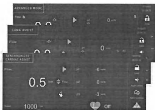
Рисунок 85 – Отображение функции нулевого потока при обнаружении пузырьков Функция нулевого потока при обнаружении пузырьков воздуха включается во время процедуры нажатием на соответствующий символ.
