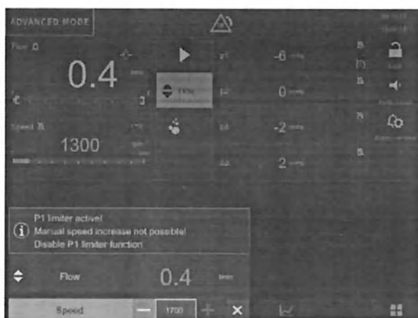
Рисунок 127 – Принцип работы ограничителя p1
