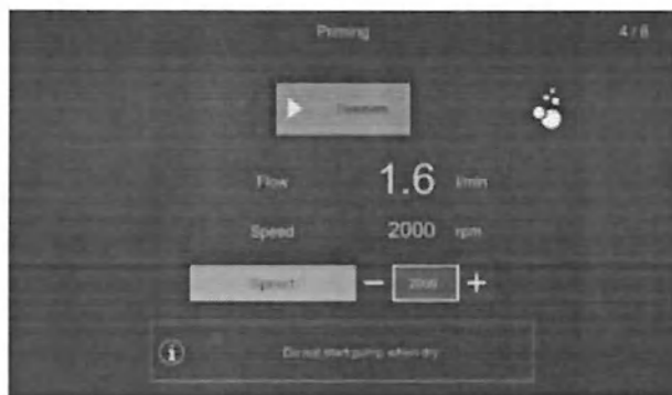
Рисунок 80 – Привод насоса работает в режиме заполнения
