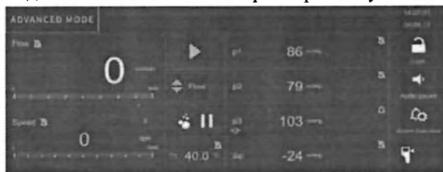
Рисунок 100 – Активация курсора с помощью поворотной ручки
