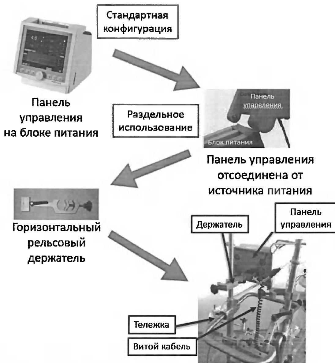
Рисунок 19 – Схема раздельного использования панели управления
