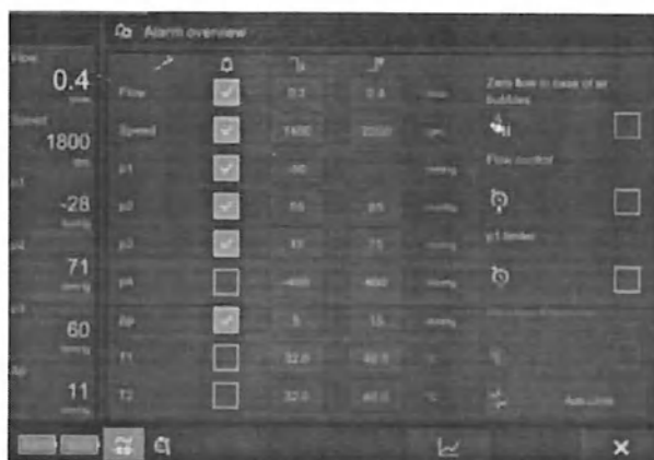
Рисунок 146 – Страница обзора пределов сигналов тревоги
