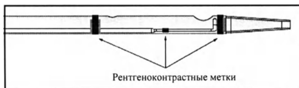
Рис. 3. Схема рентгеноконтрастных меток катетера AngioJet ZelanteDVT OVER-THE-WIRE
