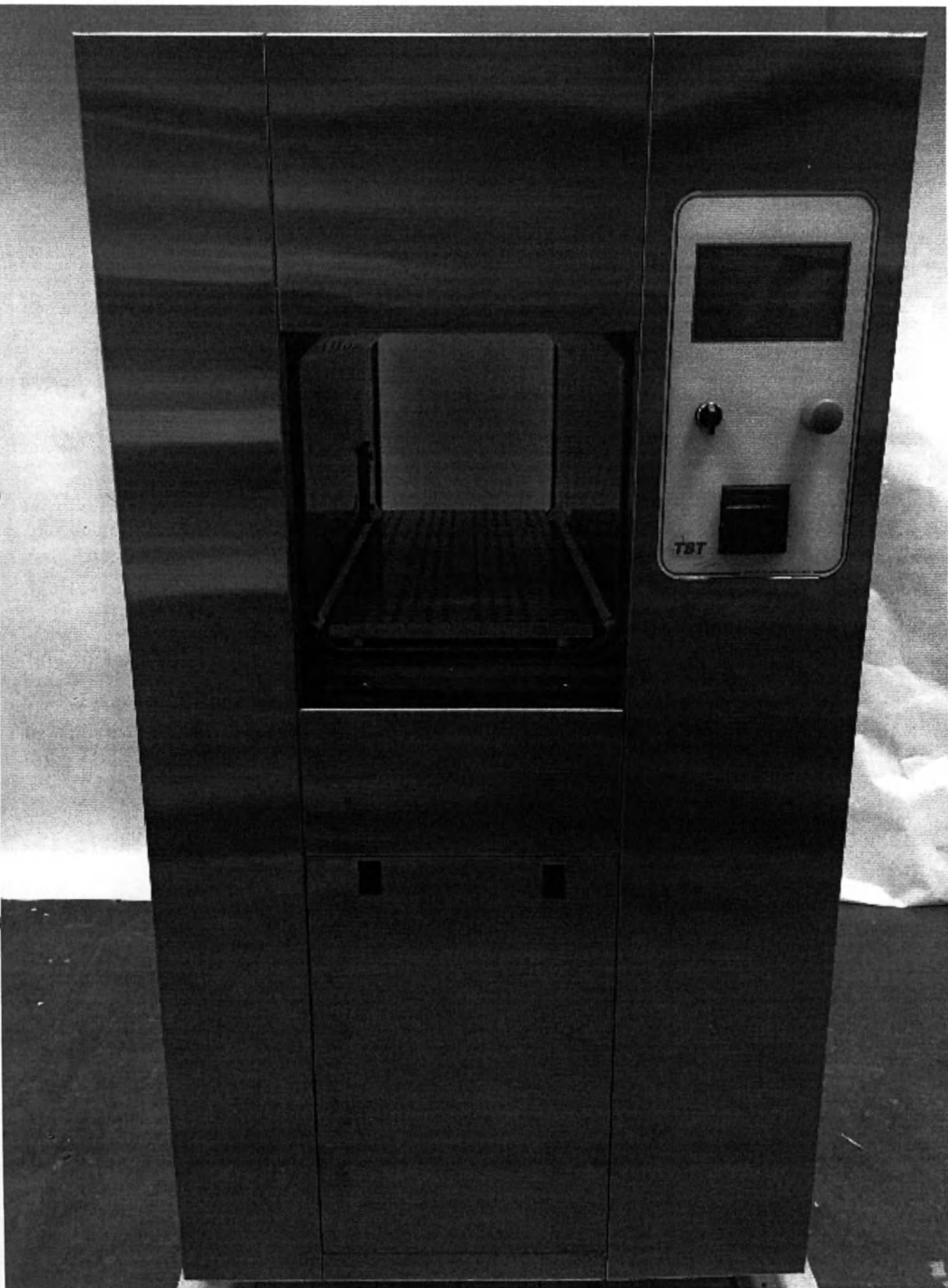
Стерилизатор паровой (вид спереди с открытой дверью)*
