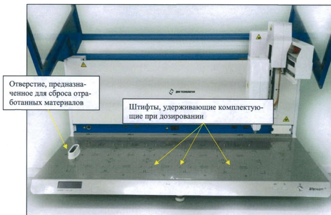
Фото 3 – Устройство дозирующее в исполнении ДТстрим 15 L4. Рабочий стол изделия имеет 15 посадочных мест для размещения дополнительного оборудования (комплектующих).
