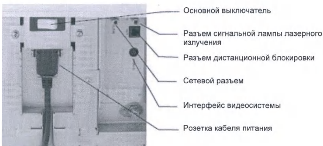
Рисунок 9: Интерфейсы блока централизованного электропитания
