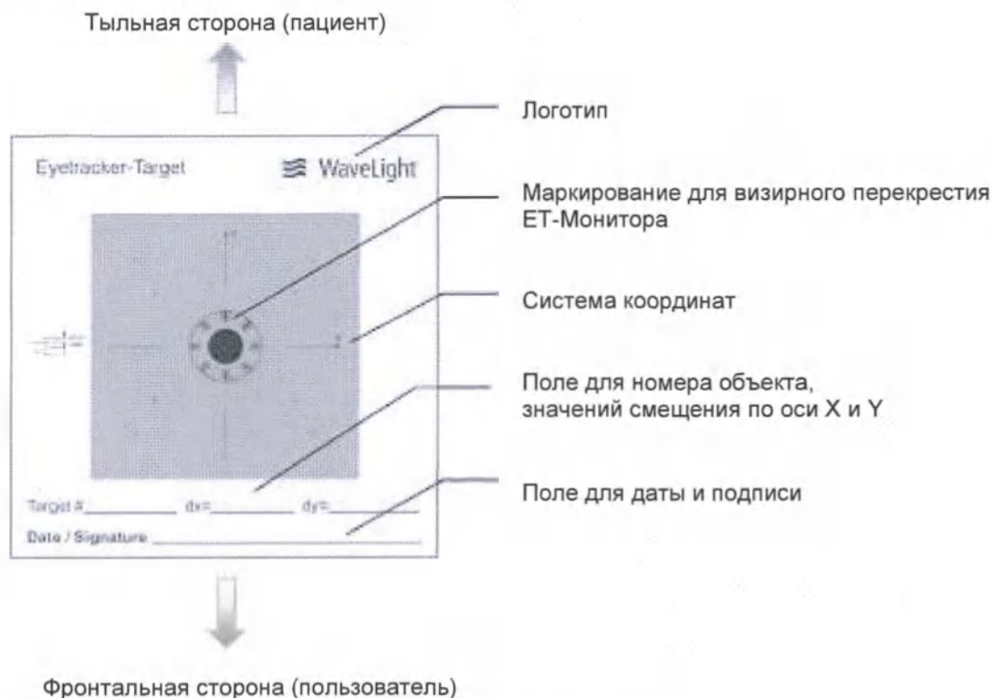
Рисунок 69: Мишень для контроля работы системы контроля положения глаза
