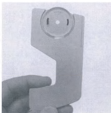
Рисунок 90: Пластина для контроля глубины абляции в держателе тестового объекта
