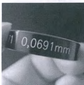
Рисунок 111: Стеклянный эталон нормальной глубины абляции (пример)
