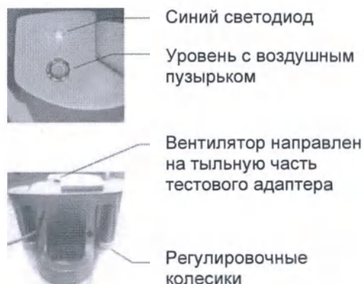
Рисунок 95: Ориентация тестового адаптера для тестирования плотности энергии
