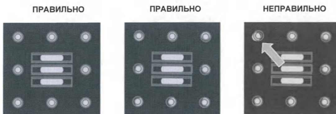
Рисунок 66: Выровненные направляющие и оценочные мишени с правильным (слева и в середине) и неправильным результатом (справа)
