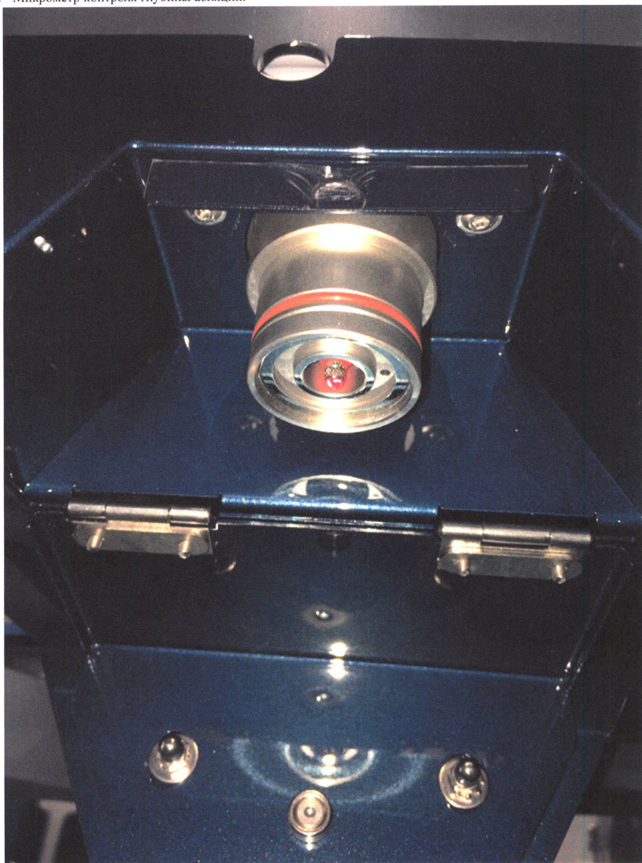
8. Микрометр контроля глубины абляции.
