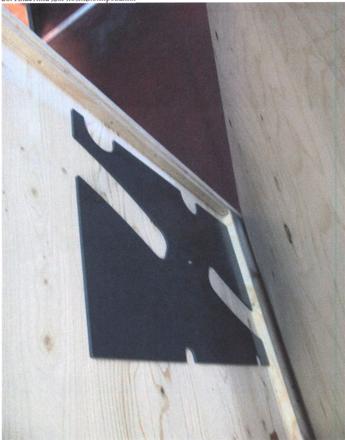
28. Пластина для позиционирования
